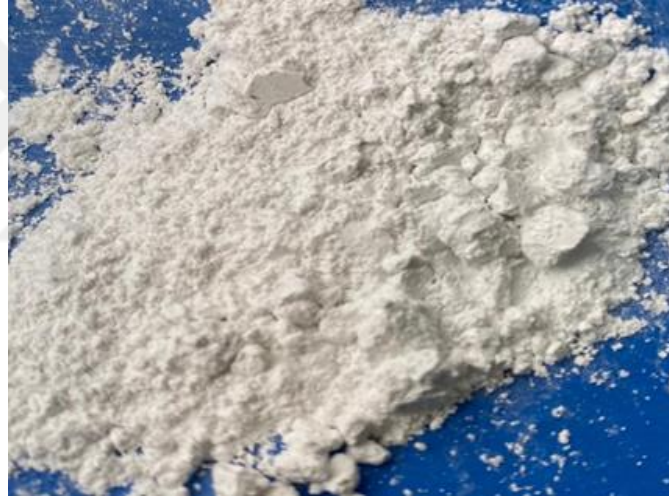
Şekil 5.3 Toz haline getirilen diş porselen tozu
