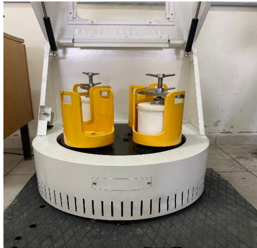
Şekil 5.8 DECO-PBM-V-0.4L gezegen bilyalı değirmen
