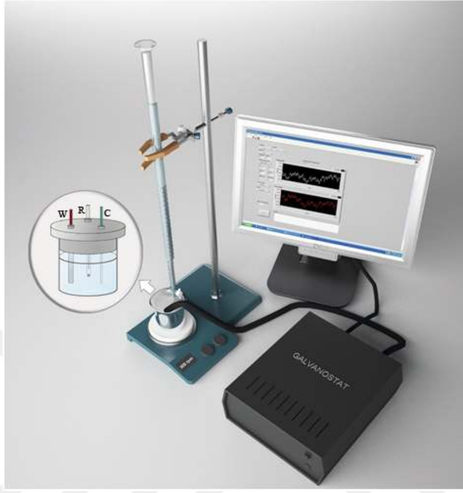
Şekil 2.12. DEIS deney düzeneği [(1) Ag/AgCl referans elektrot, (2) çalışma elektrotu, (3) Pt elektrot].
