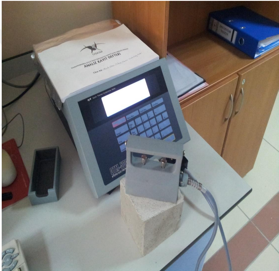
Şekil 3.17: Isı iletkenlik testi deney düzeneği
