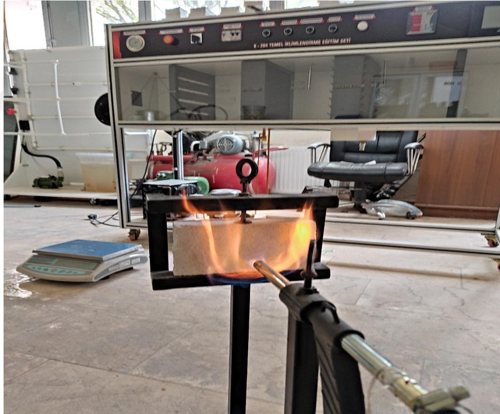
Şekil 3.18: Yanmazlık testi deney düzeneği
