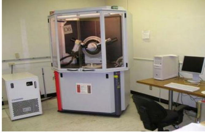
Şekil 3.21: X-ışını difraktometre (Bruker D8 Advance) cihazı
