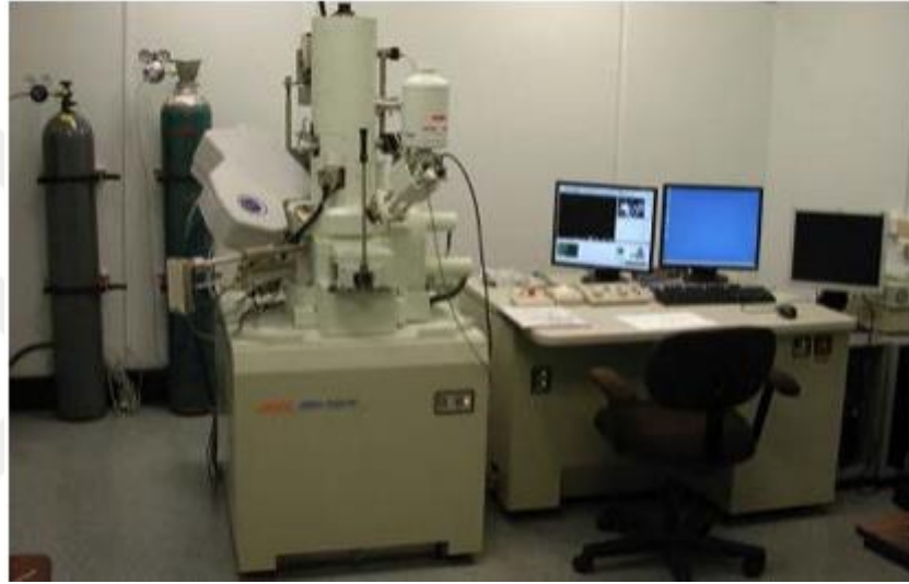
Şekil 3.19: Taramalı elektron mikroskobu (SEM, JEOL JSM 7001F) cihazı
