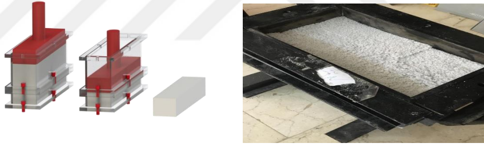
Şekil 3.8: 300x75x25mm ebatlarındaki numunelerin şekillendirilmesi
