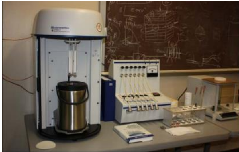
Şekil 3.20: Yüzey alanı ve gözenek boyut dağılım (BET, Micromeritics-TriStar II Plus 3030) cihazı
