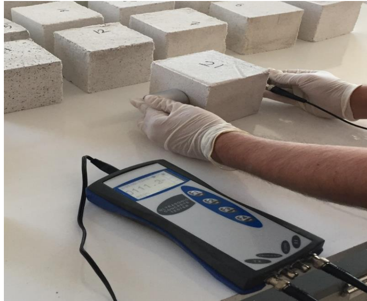
Şekil 3.16: Ultrasonik ses geçiş hızı deney düzeneği
