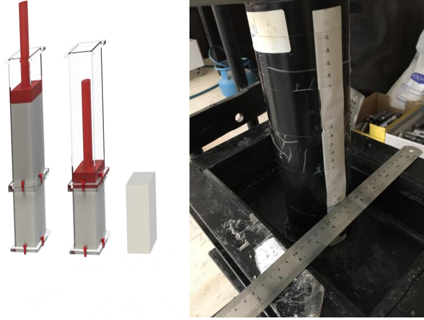
Şekil 3.7: 100x100x100mm ebatlarındaki numunelerin şekillendirilmesi
