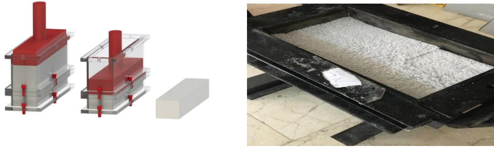
Şekil 3.8: 300x75x25mm ebatlarındaki numunelerin şekillendirilmesi
