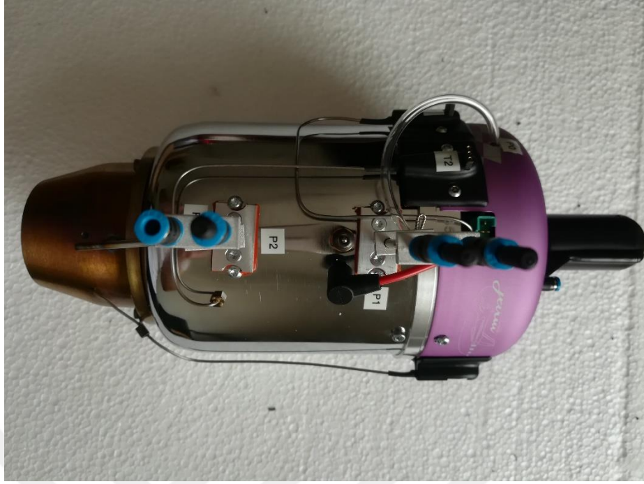
Şekil 2.14. P_1 ve P_2 basınç tüplerinin turbojet motor üzerindeki yerleşimi
