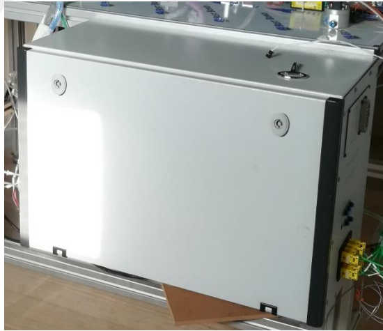
Şekil 2.19. Veri toplama panosunun dış kasası
