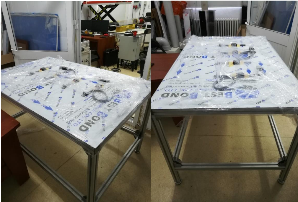
Şekil 2.6. Turbojet motor test standı: Karkas sistemi
