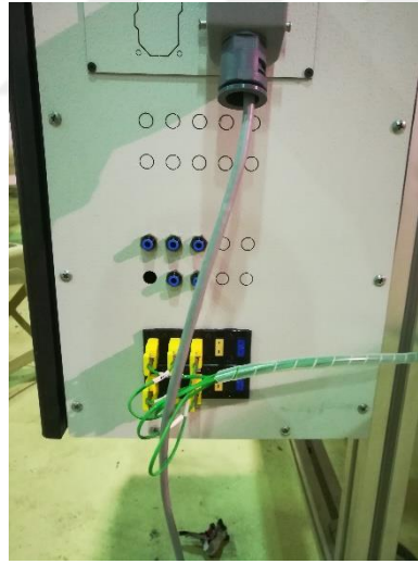
Şekil 2.21. Termokupl panel ve konnektör bağlantısı
