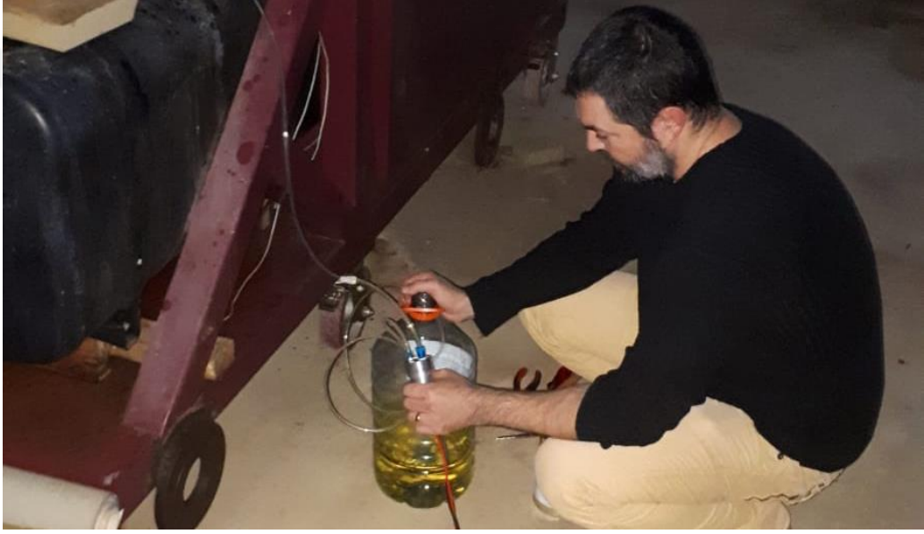
Şekil 3.14. Akış ölçerler için örnek kapalı devre yakıt hattı
