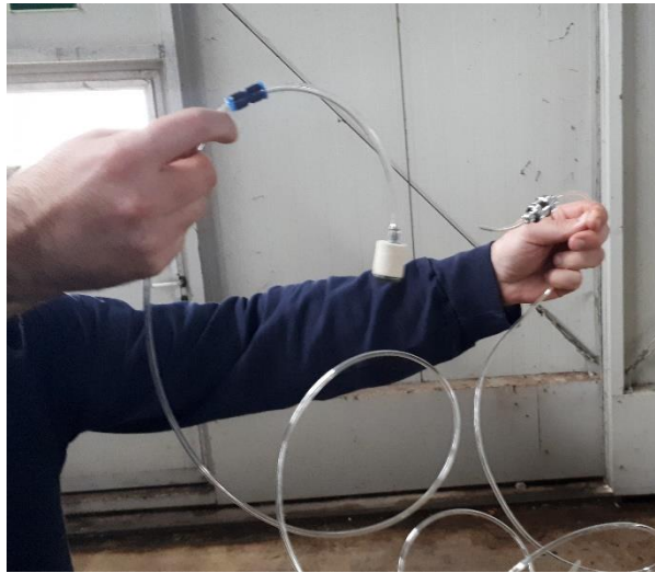
Şekil 2.18. Yakıt hattı, hızlı konnektör/nipel, yakıt ve yakıt deposu filtreleri (tank clunk)
