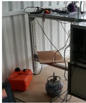
Şekil 2.29. Test standında kullanılan gaz hattı
