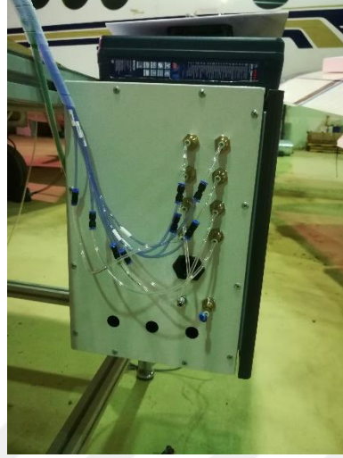
Şekil 2.22. Basınç sensörleri ve hat sistemi bağlantısı
