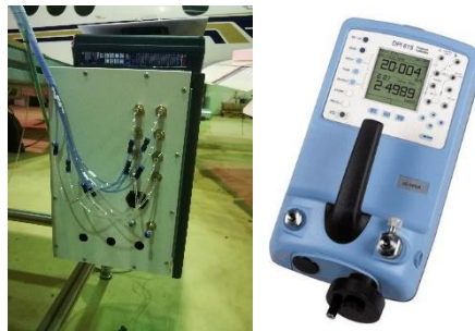
Şekil 3.13. Basınç sensörleri boru hattı ve kalibratörü
