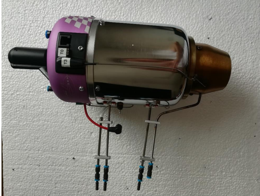
Şekil 2.13. T_0 ve T_3 termokupllarının turbojet motor üzerindeki yerleşimi
