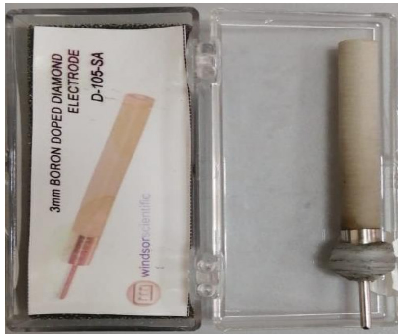
Şekil 2.9. Bor Katkılı Elmas Elektrot
