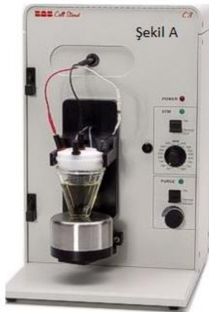
Şekil 3.1. BASI C3 katı elektrot hücresi (A) ve Autolab, PGSTAT 128N cihazı (B)
