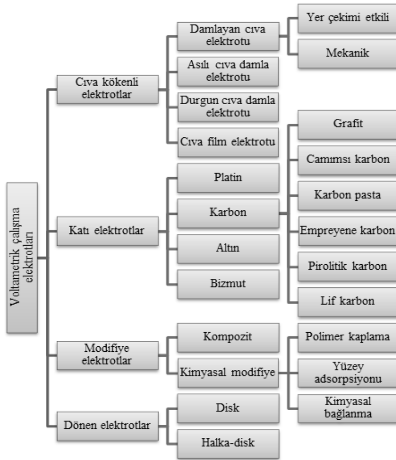
Şekil 2.7. Voltametrizde kullanılan çalışma elektrotları
