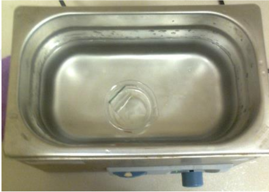
Şekil 3.1. Düz Camların P-Selecta Ultrasons Marka Sonikatörde Temizlenmesi
