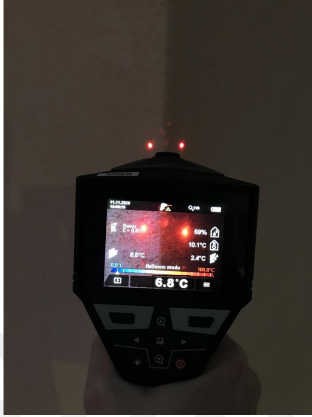
Şekil 4.6. BOSCH GIS 1000 C Professional ile dış duvar yüzey sıcaklık ölçümü
