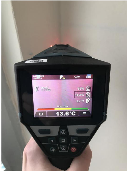
Şekil 4.4. BOSCH GIS 1000 C Professional ile ortam sıcaklığı ölçümü
