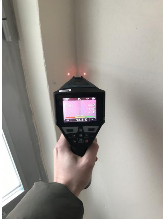
Şekil 4.7. BOSCH GIS 1000 C Professional ile iç duvar yüzey sıcaklık ölçümü
