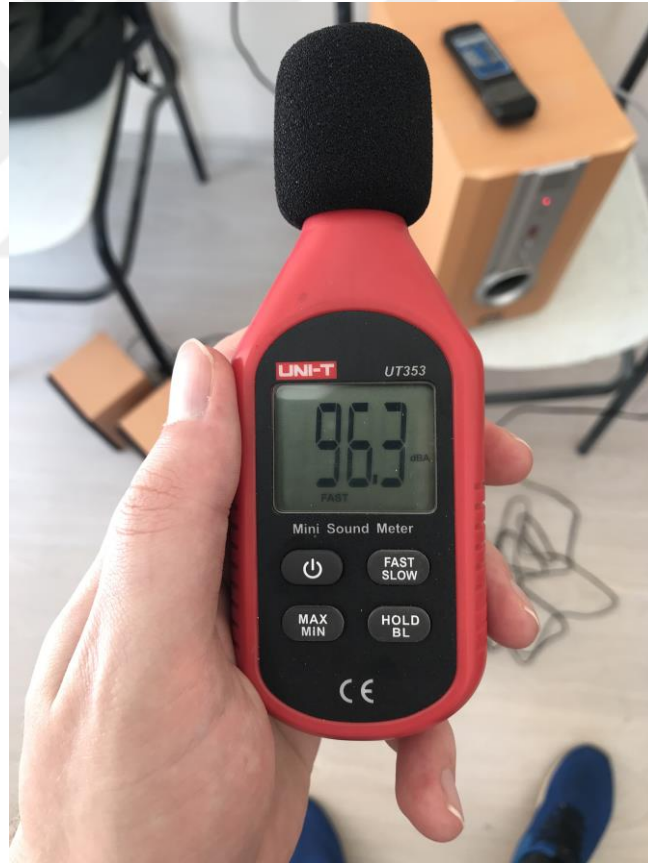
Şekil 4.14. 2000 Hz anında oda içinden desibel ölçümü
