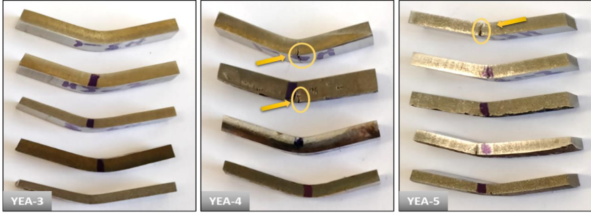
Resim 5.23. Üç nokta eğme testi sonrası YEA-3, YEA-4 ve YEA-5 numunesinin makro kırılma görüntüleri
