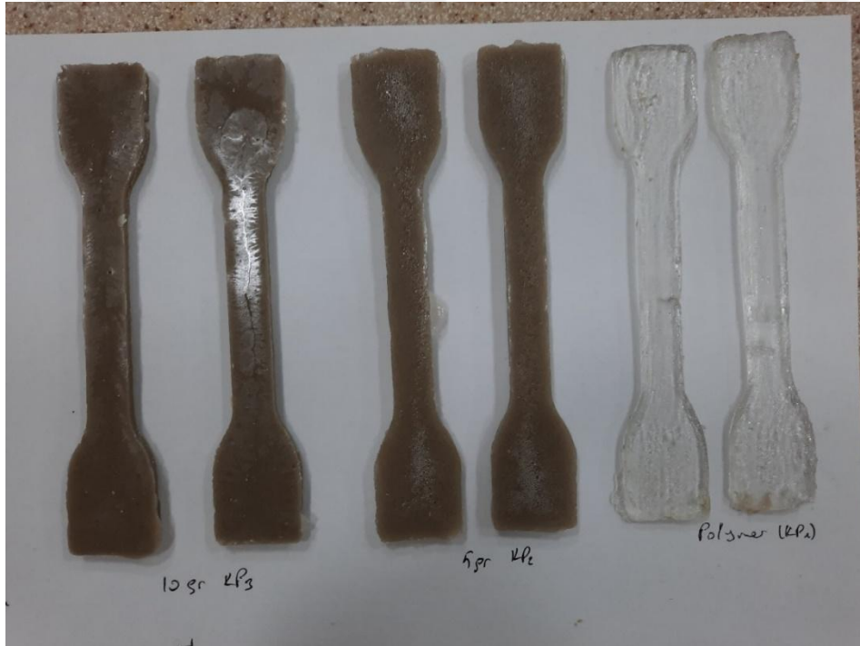
Resim 3.6 Çekme testi için kaşık kalıplara döküm.
