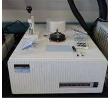
Şekil 3.6. PERKIN ELMER markalı Pyris Diamond DSC
