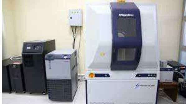
Şekil 3.14. Rigaku marka D/Max-Ultimate model X-ışını difraktometre cihazı
