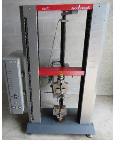
Şekil 3.12. Zwick Z010 Universal Tensile Tester
