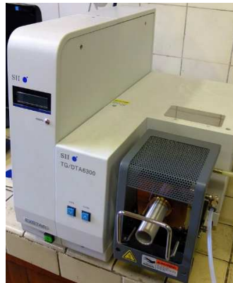
Şekil 3.7. SEIKO markalı EXSTAR SII TG/DTA 6300 model TGA cihazı
