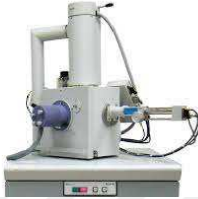
Şekil 3.8. Philips XL-30 model ESEM-FEG/EDAX cihazı
