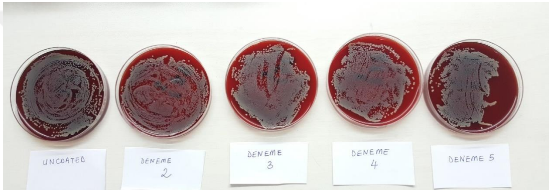
Şekil 4.10. Staphylococcus aureus ATCC suşu ile koloni sayımı sonuçları
