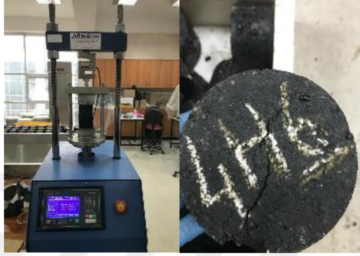
Şekil 45. Dolaylı çekme mukavemeti deneyi ve sonrasında kırılan numune
