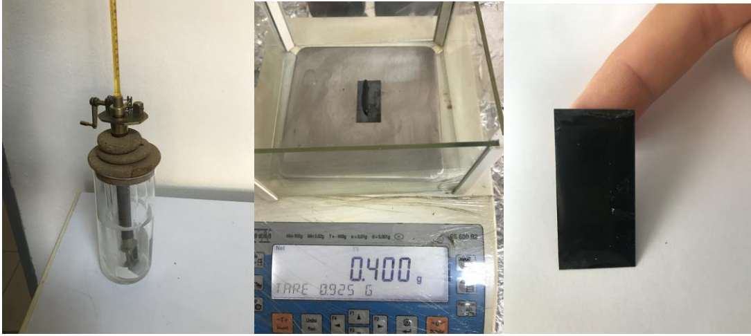
Şekil 9. Fraass kırılma noktası deney aleti ve deney sonrası çatlamanın olduğu numune
