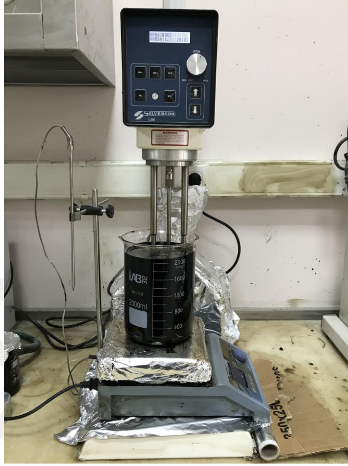
Şekil 41. Modifikasyon işleminde kullanılan yüksek hızlı parçalayıcı
