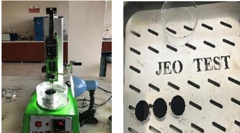
Şekil 4. Penetrasyon deney aleti ve 25°C su banyosundaki deney numuneleri
