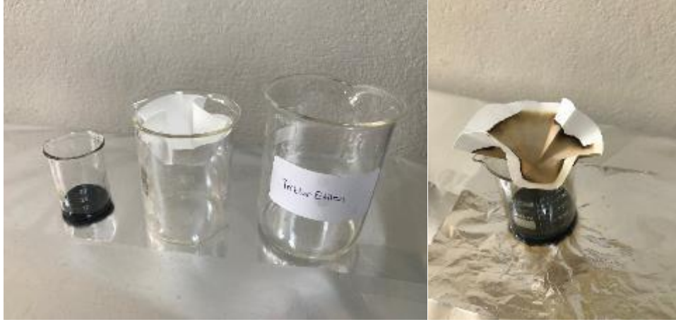
Şekil 61. %5 katkı içerikli bağlayıcının trikloretilende çözünmesi
