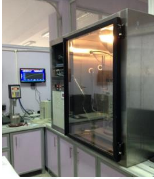
Şekil 31. Dolaylı çekme yorulma deney düzeneği (Bozdemir, 2023)
