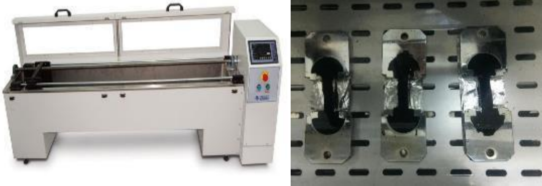
Şekil 7. Kuvvet ölçümlü düktilite cihazı ve deneye ait numuneler
