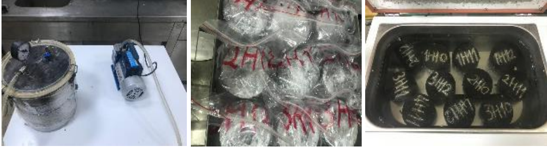
Şekil 46. Su hasarına maruz bırakılan briketlerin koşullandırma aşamaları
