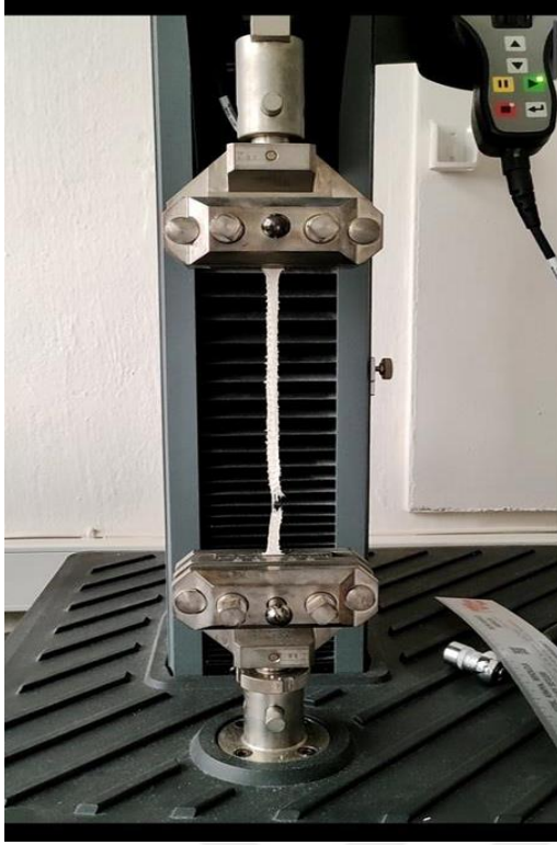
Şekil 4.31 : Süprem kumaş yüzeyine üleksit (sağ) ve kolemanit (sol) katkılı sol-jel kaplı kumaş yapılarının çekme test görüntüleri.
