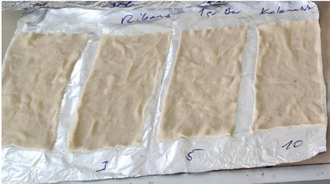
Şekil 3.7 : Ribana kumaş yapılarına yapılan kolemanit-sol-jel kaplamalar.
