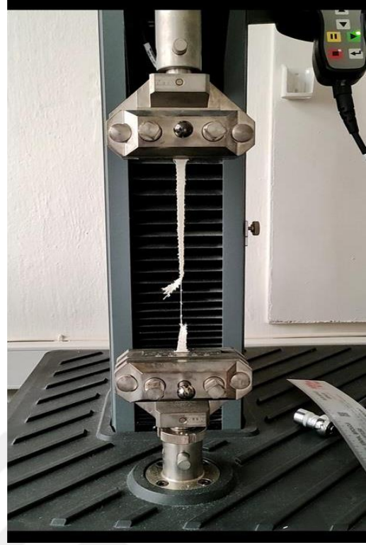
Şekil 4.31 : Süprem kumaş yüzeyine üleksit (sağ) ve kolemanit (sol) katkılı sol-jel kaplı kumaş yapılarının çekme test görüntüleri.
