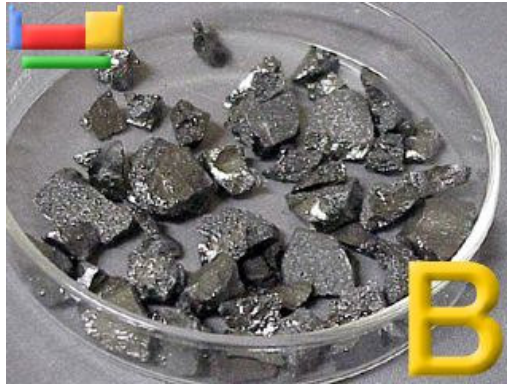
Şekil 3.1. Bor elementinin görünümü ( http://www.webelements.com/boron )
