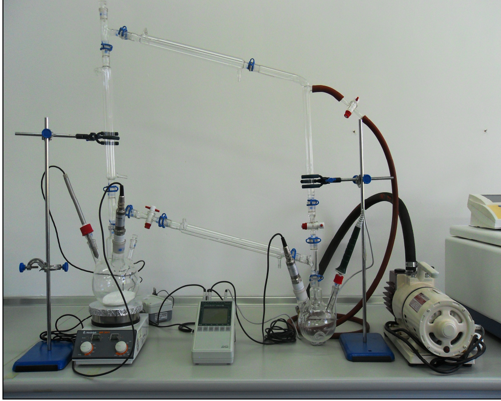
Şekil 4.40. Katı gaz tepkimesine dayalı ısı depolama ve ısı pompalama sistemi deney düzeneđi
