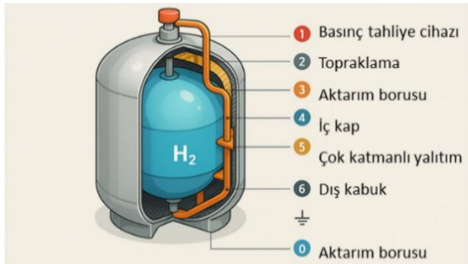
Şekil. 2.10: LH 2 tanklarının yapısı (Xie ve diğ., 2024)
