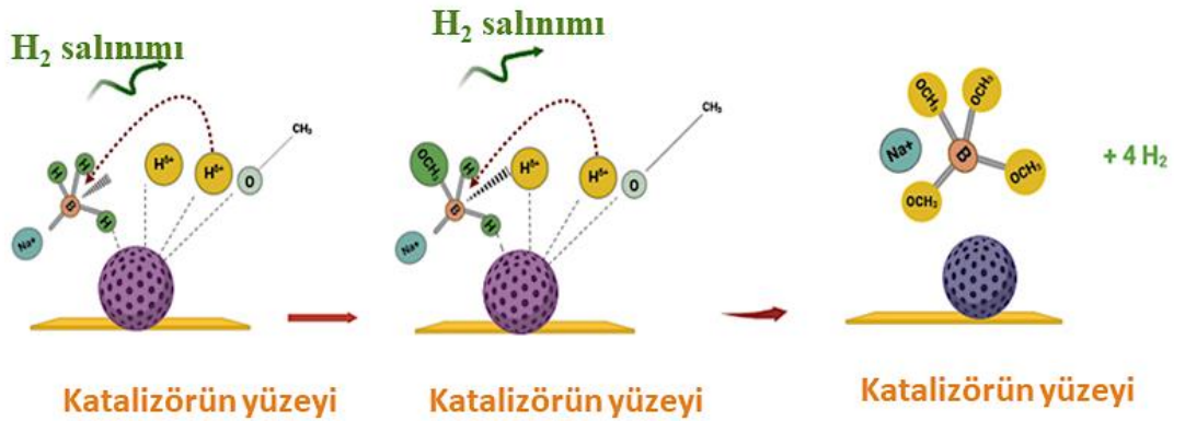
Şekil 4.6. Sentezlenen Fe_3O_4 manyetik nanoparçacıkları için önerilen hidrojen üretim mekanizması
