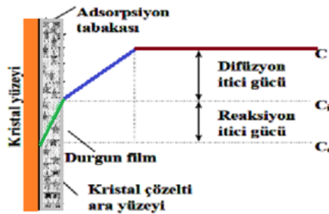
Şekil 2.7 Difüzyon ve yüzey entegrasyonu (reaksiyon) için konsantrasyon itici güçleri
