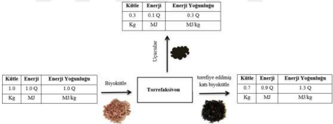
Şekil 3.1. Biyokütlenin torrefaksiyon süreci boyunca kütle ve enerjisindeki değişimler [44]
