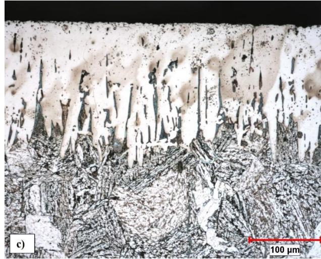
Şekil 4.3 1000 °C sıcaklıkta borlanmış 17CrNiMo6 çeliğinin optik mikroskop altında incelenen kesit mikro yapıları, a) 2 saat, b) 4 saat, c) 6 saat
