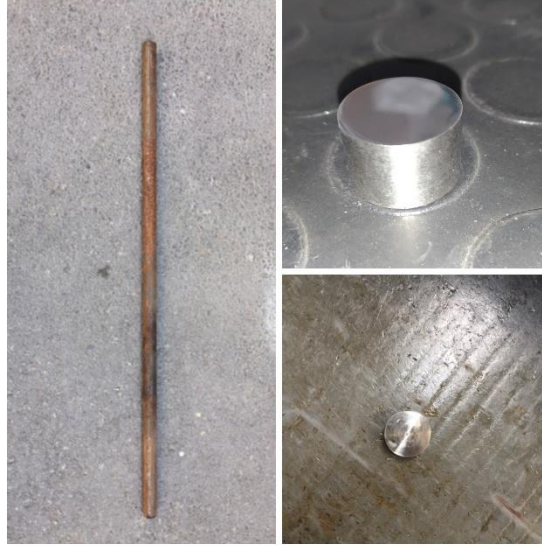
Resim 3.1 Ø30 mm çaplarındaki DIN 17 CrNiMo6 sementasyon çeliği.
