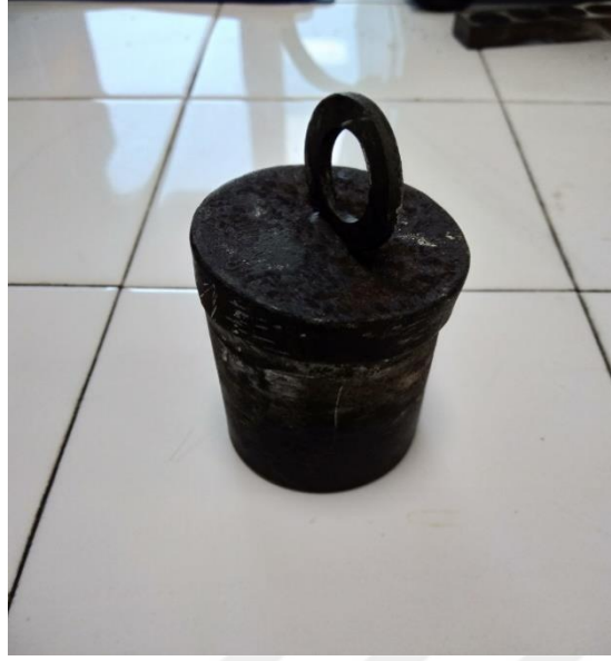
Resim 3.3 Borlama işleminde kullanılan paslanmaz çelik pota.
