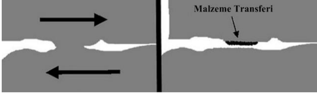
Şekil 2.12 Adhesiv aşınma oluşum mekanizması (Affatato and Brando 2013).
