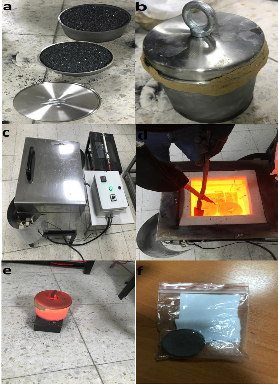
Şekil 3.2 Çeliklerin borlama prosesi öncesi ve sonrası süreçleri a) Numunelerin potaya yerleştirilmesi, b) Potanın şamot çamuru ile kapatılması, c) Borlama işleminin yapıldığı kuyu fırını, d) Numunelerin fırında çıkarılması, e) Soğumaya bırakılması, f) Bir sonraki işlem için hazırlanması
