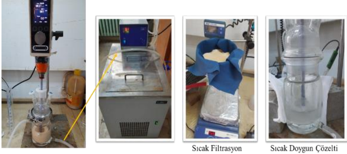
Şekil 11. Sıcak kolemanit liç deney düzeneği
