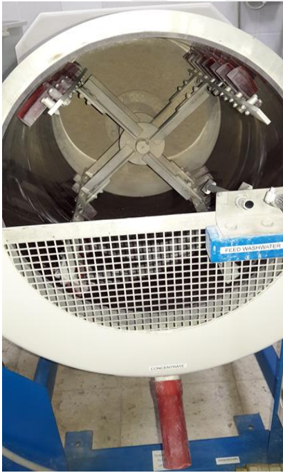
Resim 4.3 MGS yoğun malzeme çıkış kısmı ve iç dizaynındaki küreyiciler.
