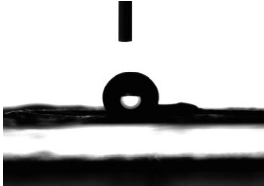
Şekil 4.3. PBFM-1 membranına ait yüzey temas açısı görüntüsü
