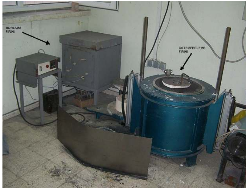
Şekil 6.4 Borlama ve Östemperleme işlemlerinde kullanılan fırınlar.
