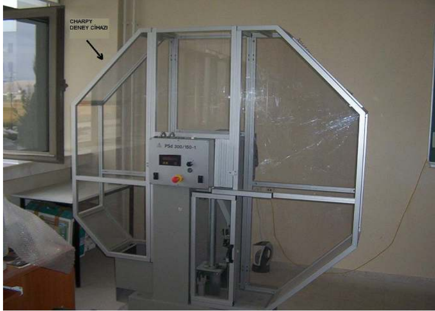
Şekil 6.7 Charpy deneyinde kullanılan cihazın şekli.
