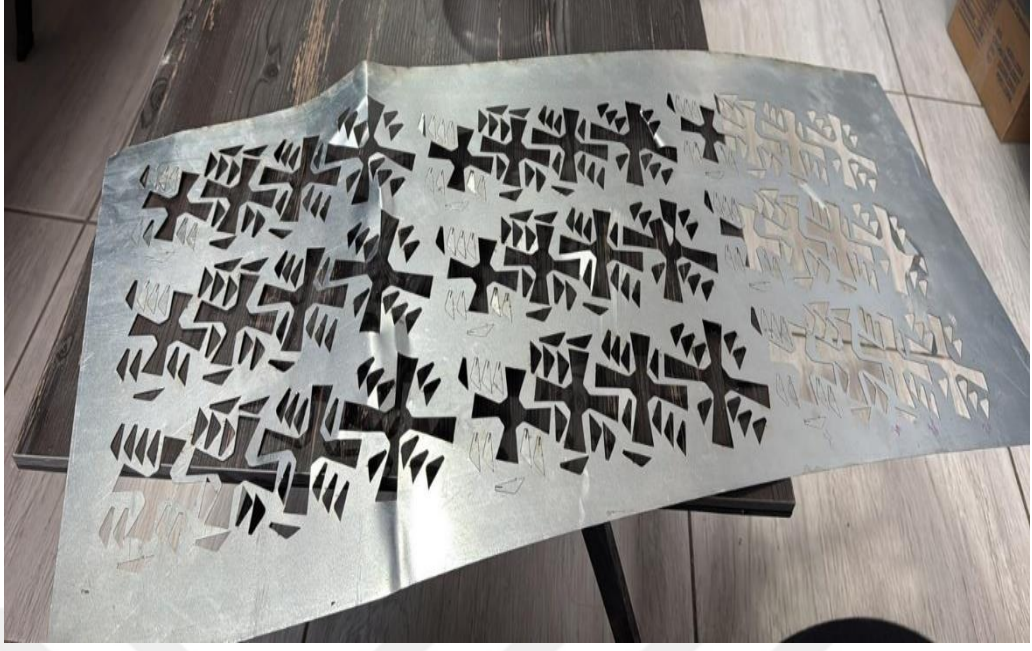
Şekil 6.2. a) Türbülâtörün autocad ile çizimi, b) Lazer makinesinde kesim c) Türbülâtörlerin lazer ile kesilmiş görüntüsü
