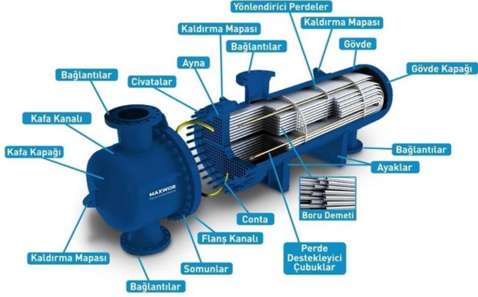
Şekil 4.5. Gövde borulu ısı değıştircilerin yapısı (Caner, 2024).
