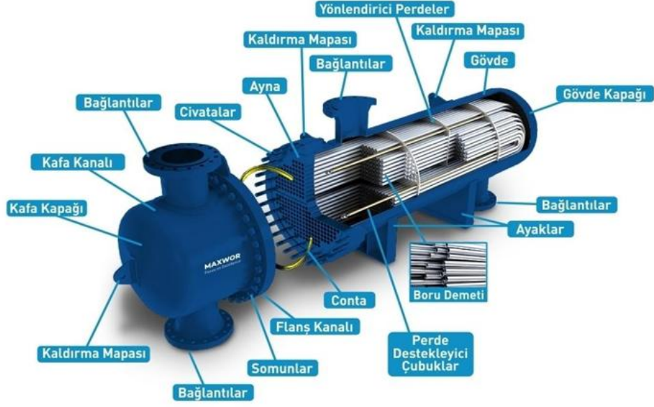
Şekil 4.5. Gövde borulu ısı değıştircilerin yapısı (Caner, 2024).
