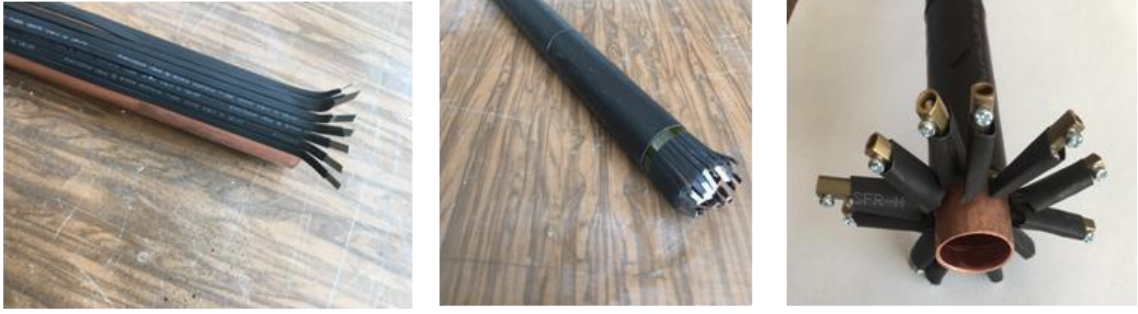
Şekil 13. Test bölgesi ısıtıcı kabloları
