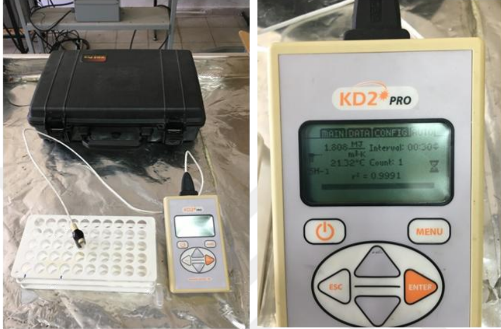
Şekil 6. Isı iletim katsayısı ve özgül ısı ölçüm cihazları
