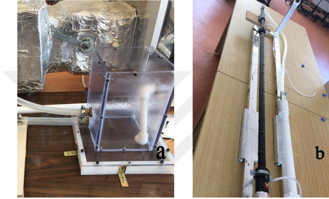
Şekil 17. Tank bölgesi ve dönüş hattı
