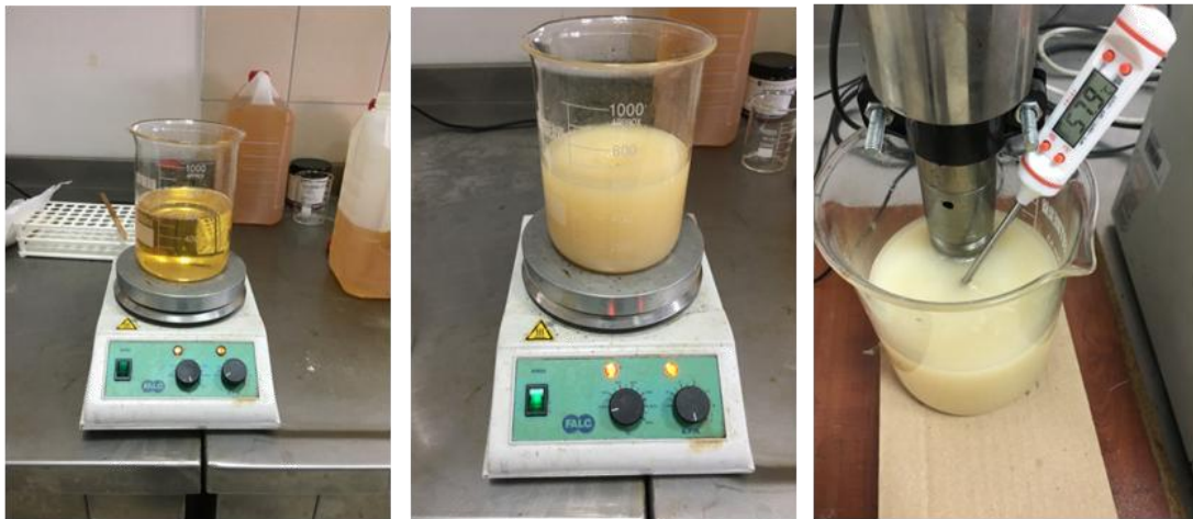
Şekil 4. Manyetik ve Ultrasonik karıştırıcı görüntüleri
