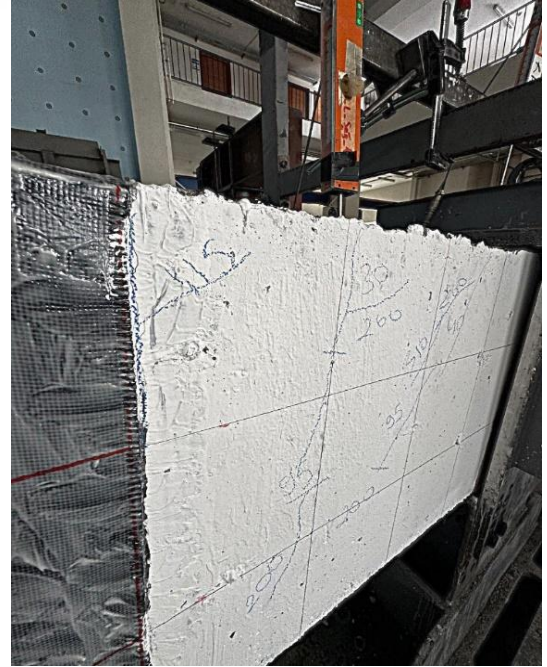
Şekil 57. B1-DEF- RET –WO numunesinin deney sonrası çatların görünümü
