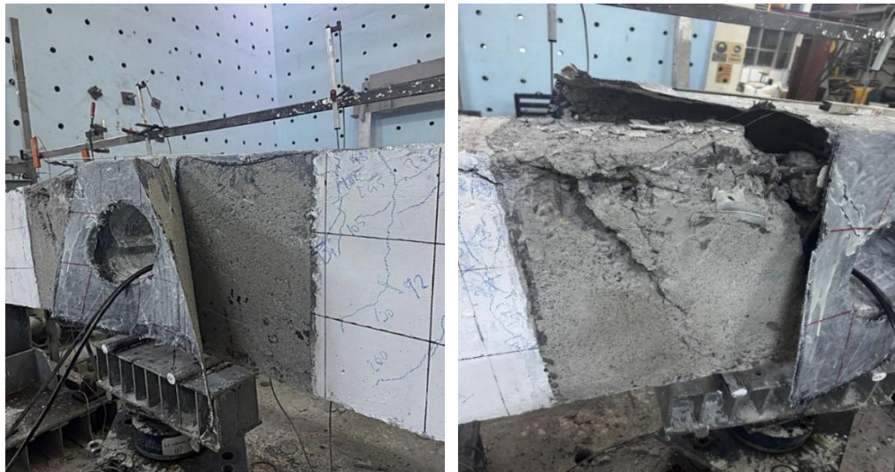
řekil 66. B2-RET-WO numunesinin hasar daęılımları
