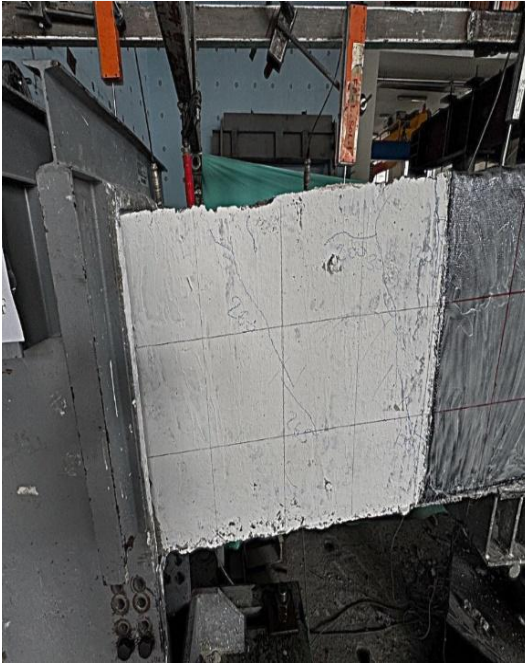
Şekil 57. B1-DEF- RET –WO numunesinin deney sonrası çatların görünümü
