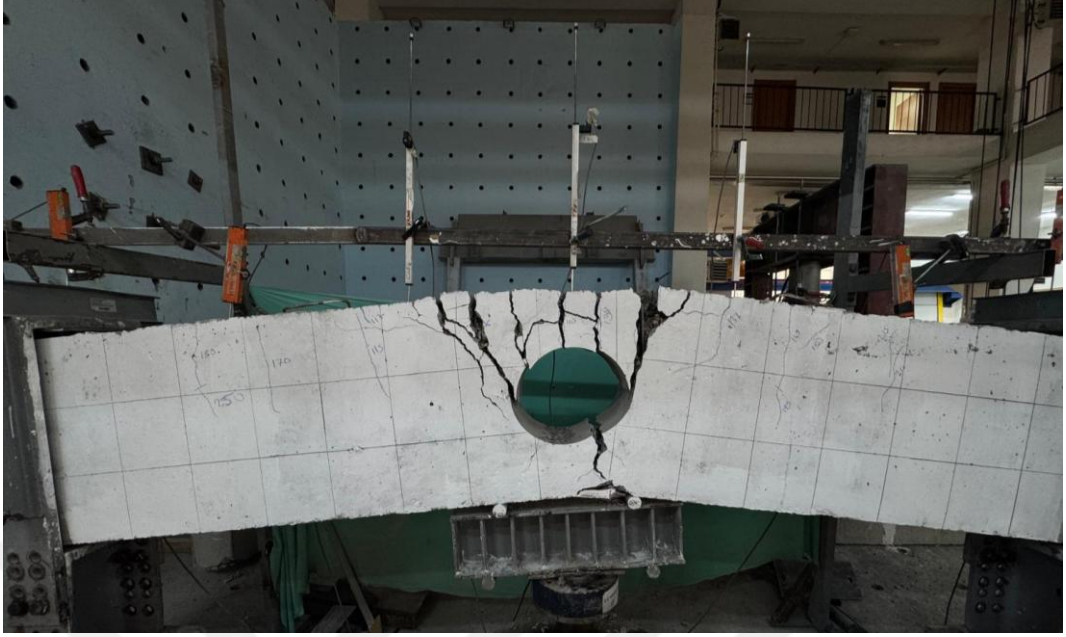
Şekil 48. B-REF-WO numunesinin deney sonrası eğilme çatlağı
