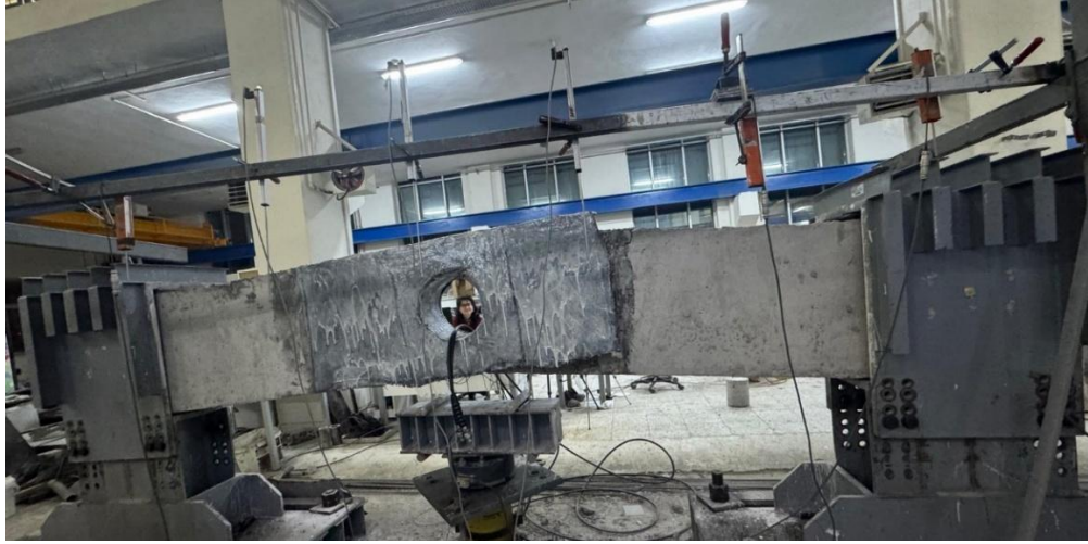
Şekil 67. B2-RET-WO numunesinin hasar dağılımları
