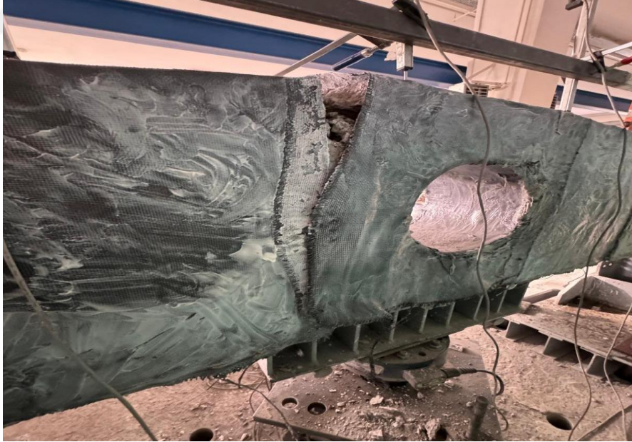
Şekil 59. B1-DEF- RET –WO numunesinin deney sonrası hasarlı görünümü
