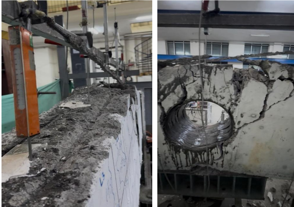
Şekil 82. B5-RET-ROP-WO numunesinin hasar görünümü
