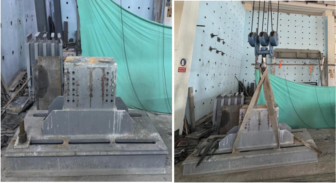
Şekil 20. Çelikten imal edilmiş mesnet ayakları ve vinç ile düzeneğe yerleşimi
