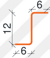
Şekil 3.2 Kesme donatı detayı (cm biriminde ölçüler)
