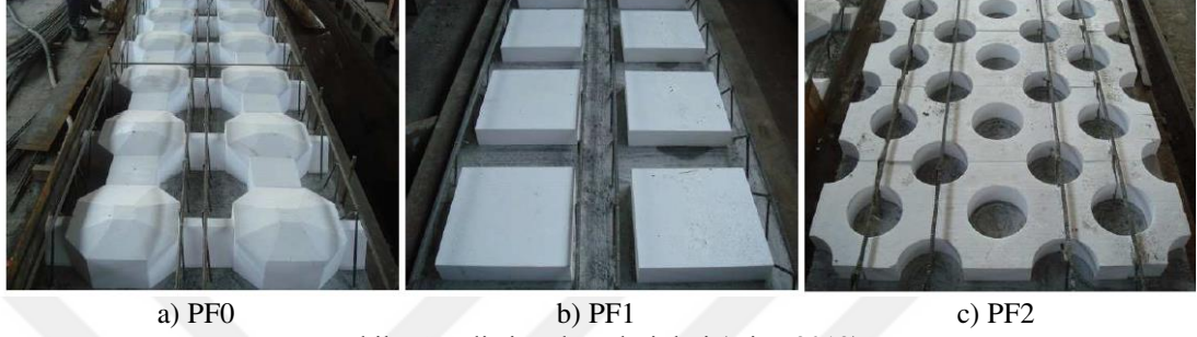
Şekil 2.3 Polistiren köpük tipleri (Kim, 2012)
