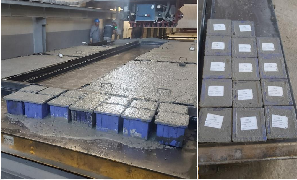
Şekil 3.14 Beton numunelerinin alımı
