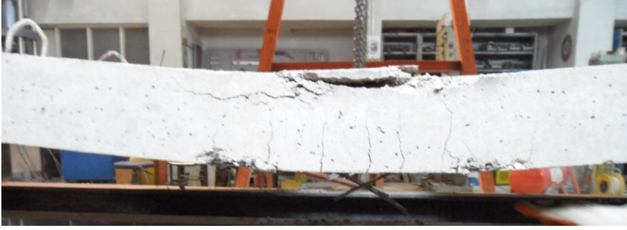
Resim 4.27. 12 numaralı eleman eğilme çatlağı, basınç ezilmesi
