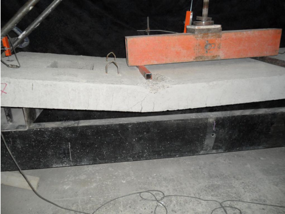
Resim 4.16. 7 numaralı elemanın kesme çatlağı
