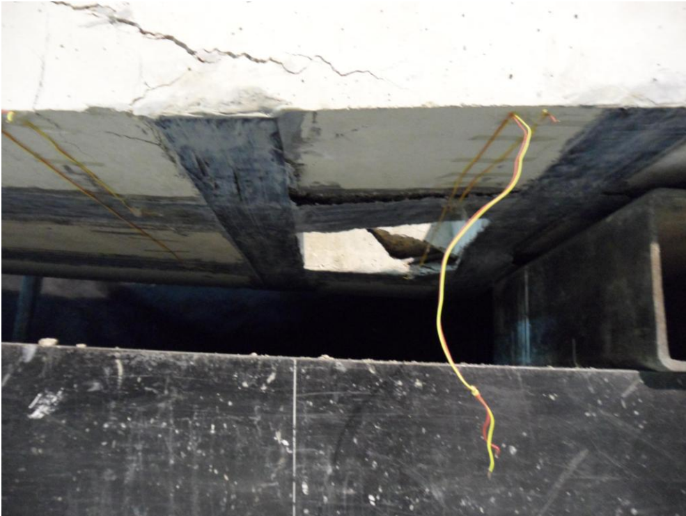
Resim 4.30. 13 numaralı elemanda yüzeyden soyulan CFRP şeritler
