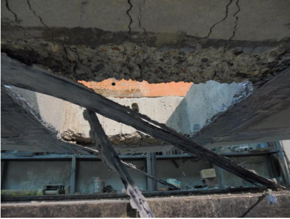
Resim 4.23. 10 numaralı elemanda kopan CFRP şeritler
