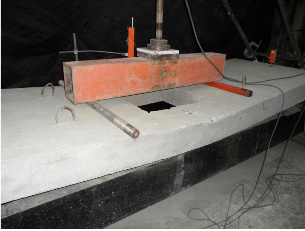
Resim 4.4. 2 numaralı elemanda oluşan basınç ezilmesi
