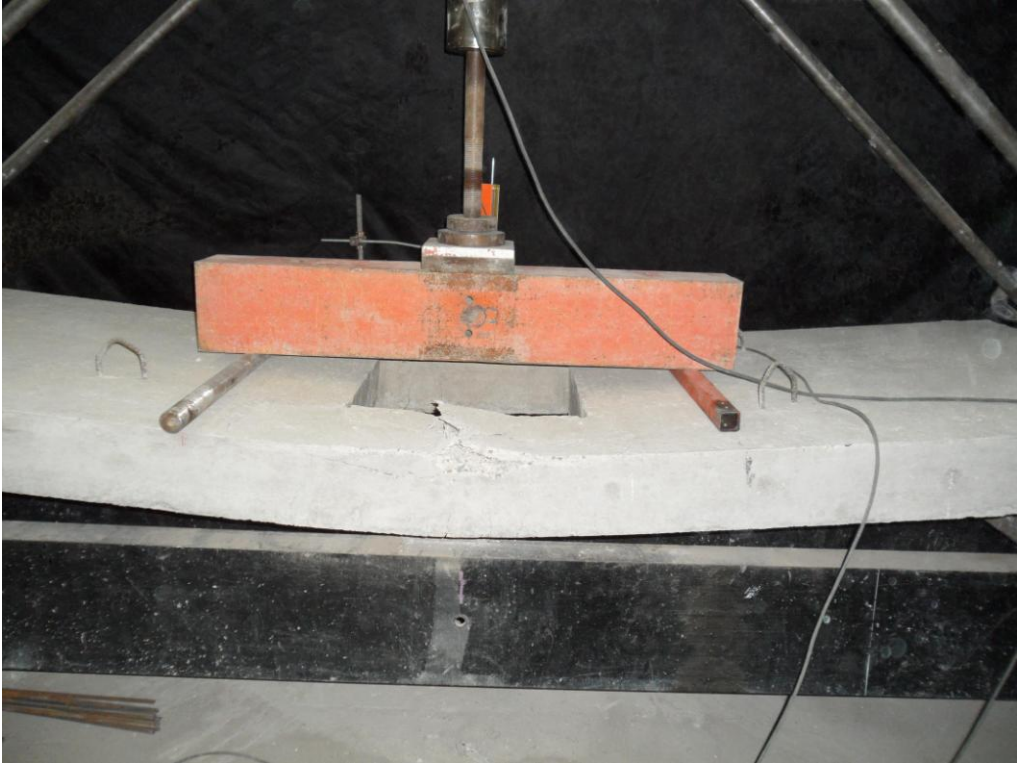
Resim 4.5. 2 numaralı elemanın deformasyonu
