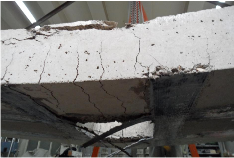
Resim 4.28. 12 numaralı elemanda kopan CFRP şeritler
