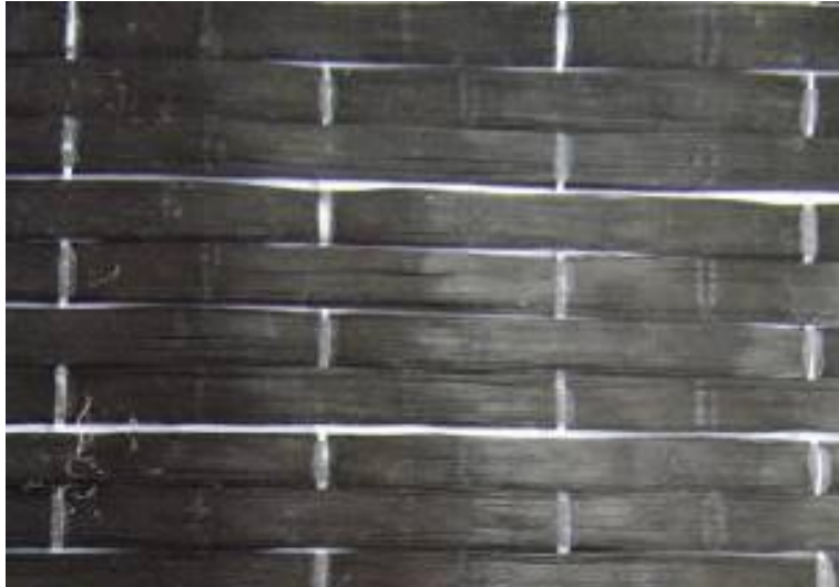
Resim 2.3. Tek yönlü CFRP şeritler
