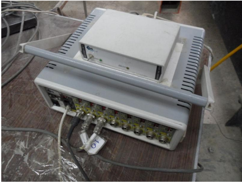
Resim 3.3. Verilerin bilgisayara aktarılmasında kullanılan data logger
