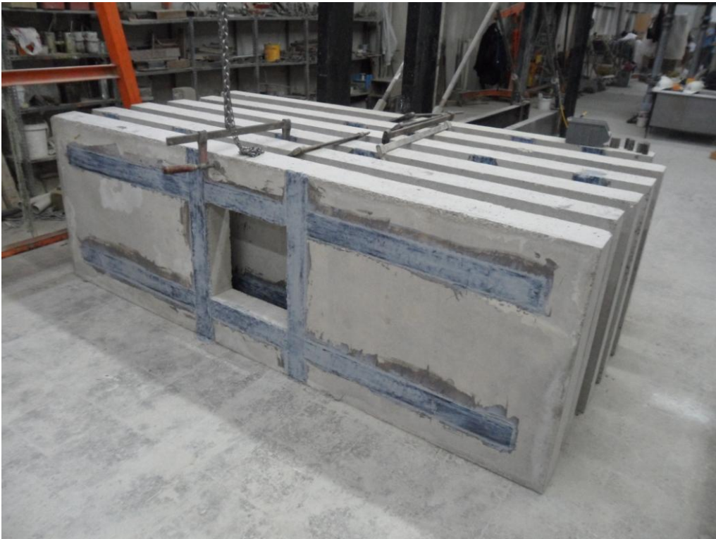
Resim 2.5. Güçlendirilmiş deney elemanları
