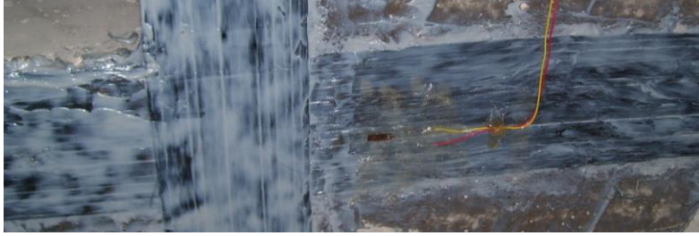
Resim 3.2. CFRP üzerindeki birim deformasyon ölçer
