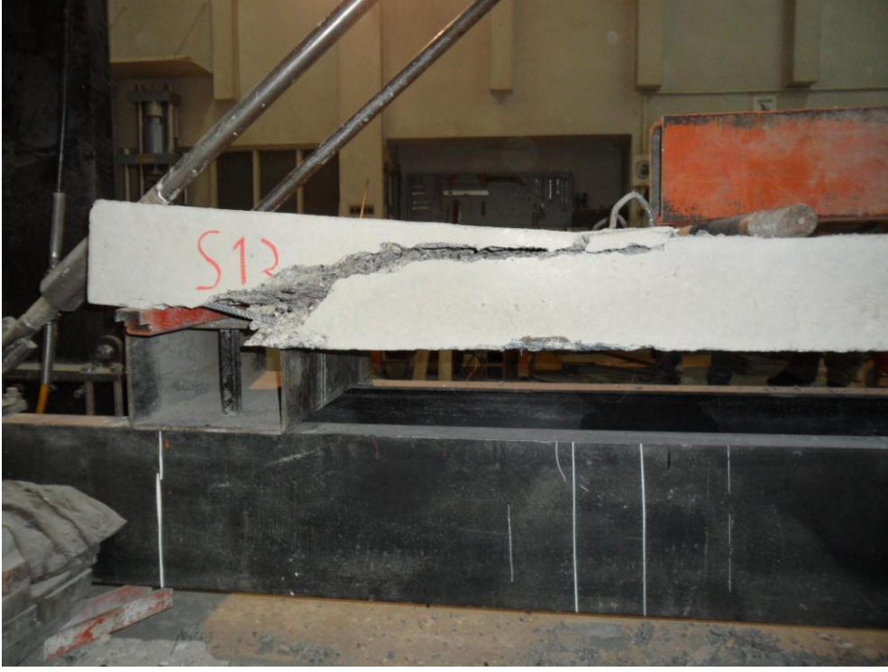
Resim 4.29. 13 numaralı elemanda oluşan kesme çatlağı
