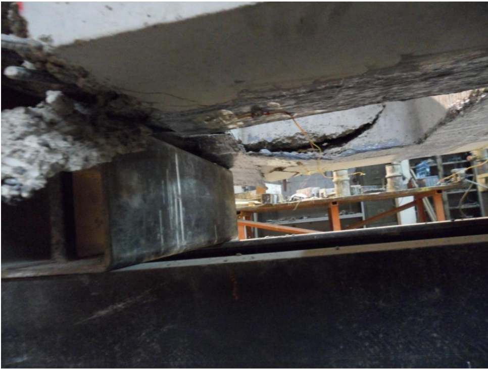
Resim 4.26. 11 numaralı elemanda yüzeyden soyulan CFRP şeritler
