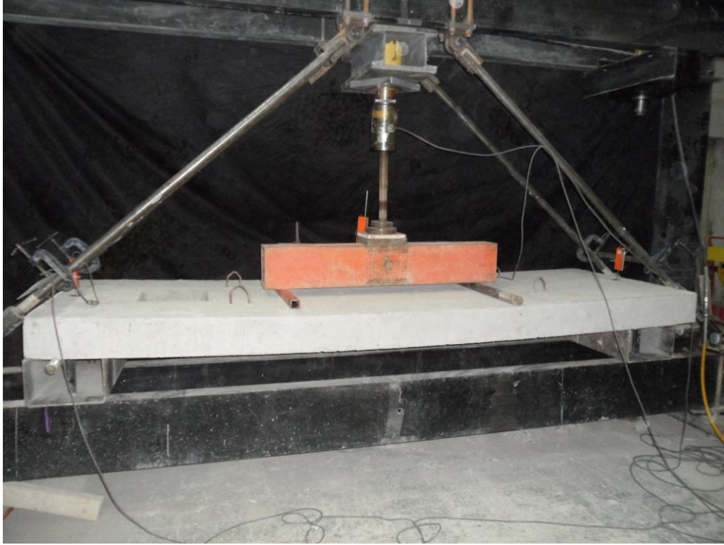
Resim 3.1. Yükleme düzeneđi ve kapalı çerçeve sistemi
