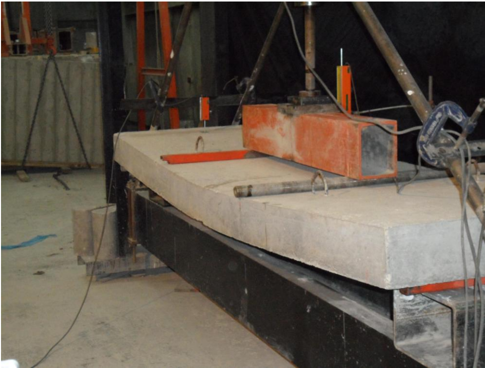
Resim 4.2. Referans elemanın deformasyonu
