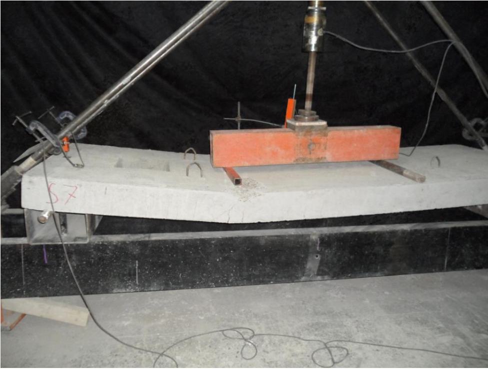
Resim 4.18. 7 numaralı elemanın deformasyonu
