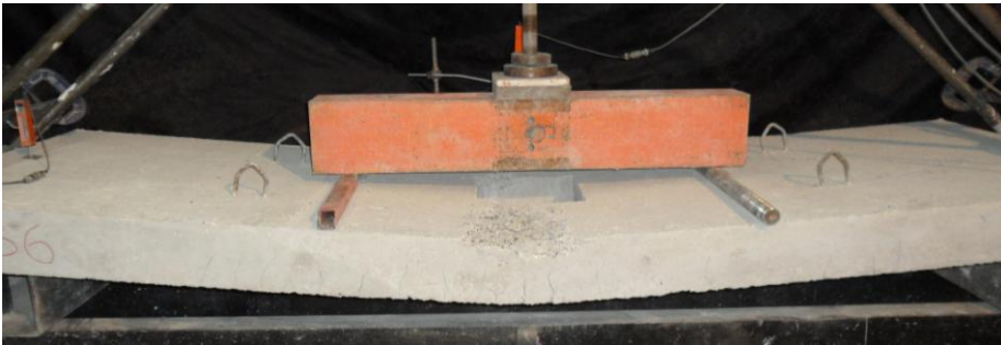
Resim 4.15. 6 numaralı elemandaki basınç ezilmesi ve deformasyon
