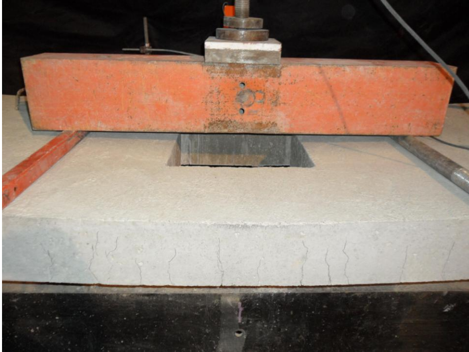
Resim 4.9. 4 numaralı elemanın eğilme çatlakları
