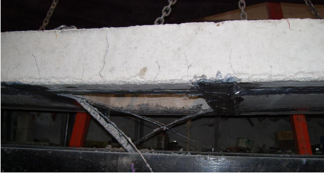
Resim 4.19. 8 numaralı elemanda kopan CFRP şeritler
