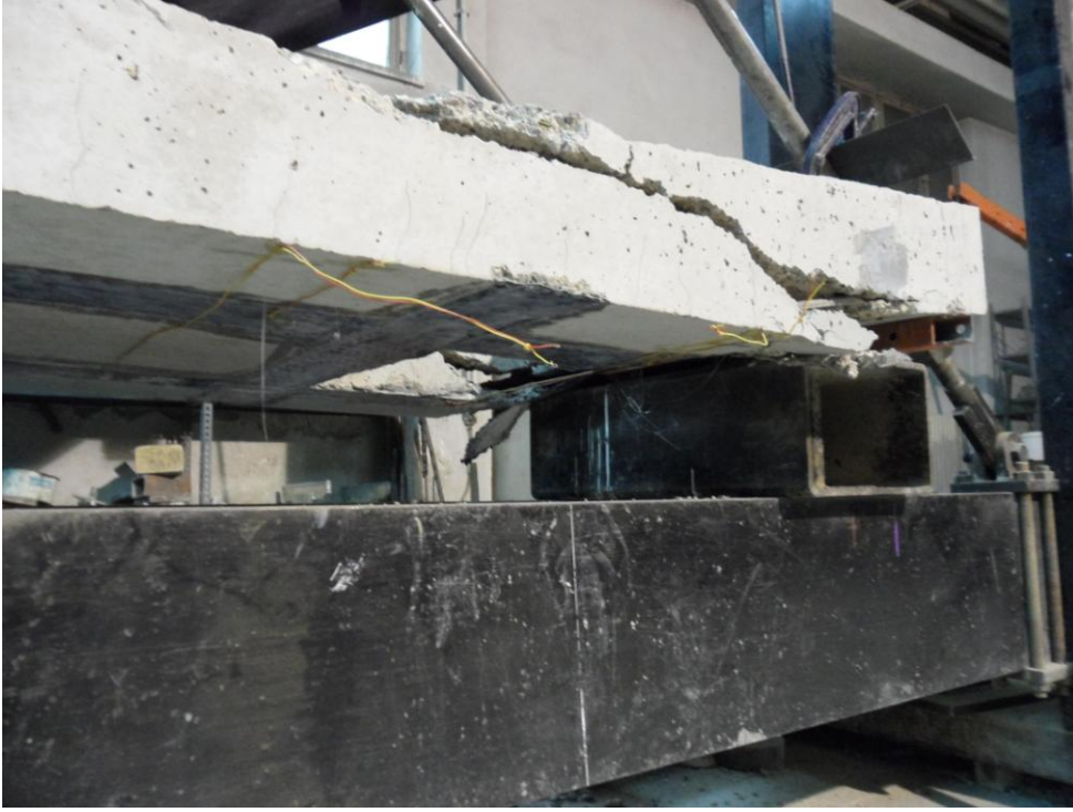
Resim 4.25. 11 numaralı elemanda oluşan kesme çatlağı
