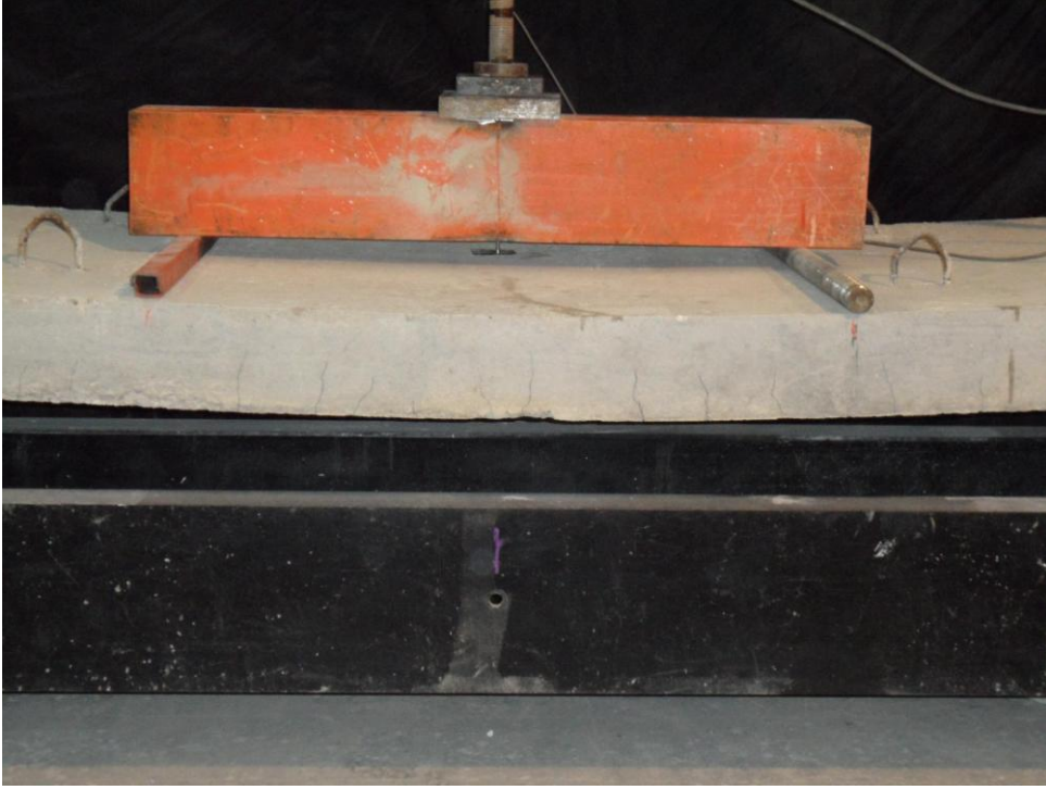
Resim 4.1. Referans elemanı eğilme çatlakları
