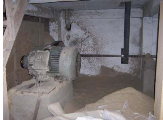
Foto Ek 1.235 Şamlılar Çeltik Fabrikası, Z-04 Üretim 1 mahallinde makineleri çalıştıran güç kaynağı elektrik motoru, Nisan 2004.
