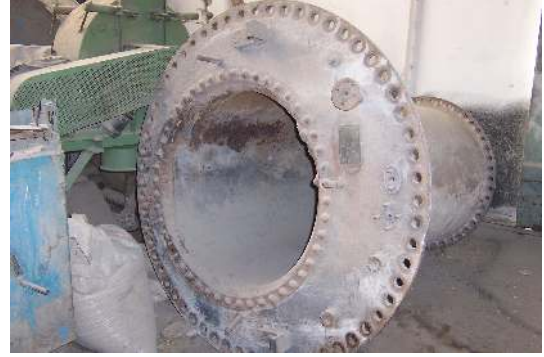
Foto Ek 1.139 Tosya, Bektaş Çeltik Fabrikası, “lokomobil” adı verilen buhar gücü üreten güç kaynağından sökülmiş bir brülör, Kasım 2005
