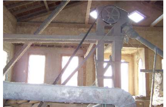
Foto Ek 1.285 Şamlılar Çeltik Fabrikası, 2-01 Üretim 3 mahalli, temizlenen pirinçleri ambara taşıyan asansör ve kanalları, Nisan 2004
