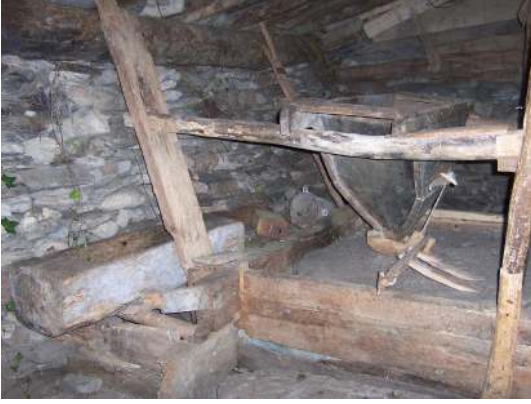
Foto Ek 1.70 Gazidere Tabaklısı, Ahmet Bican Değirmeni, çakıldaklar, buğday teknesi ve arkasında hak alma oluğu, Ekim 2003
