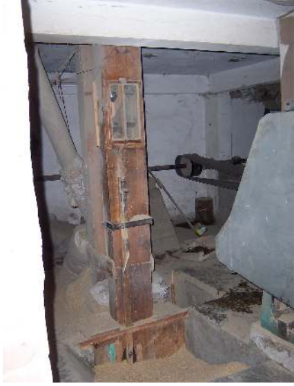
Foto Ek 1.236 Şamlılar Çeltik Fabrikası, Z-04 Üretim 1 mahallinde çeltiğin verildiği “ağız” bölümü ve ilk asansör, Nisan 2004
