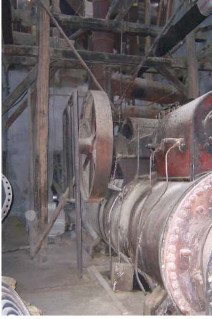
Foto Ek 1.141 Tosya, Bektaş Çeltik Fabrikası, “lokomobil” adı verilen buhar gücü üreten güç kaynağı, Kasım 2005
