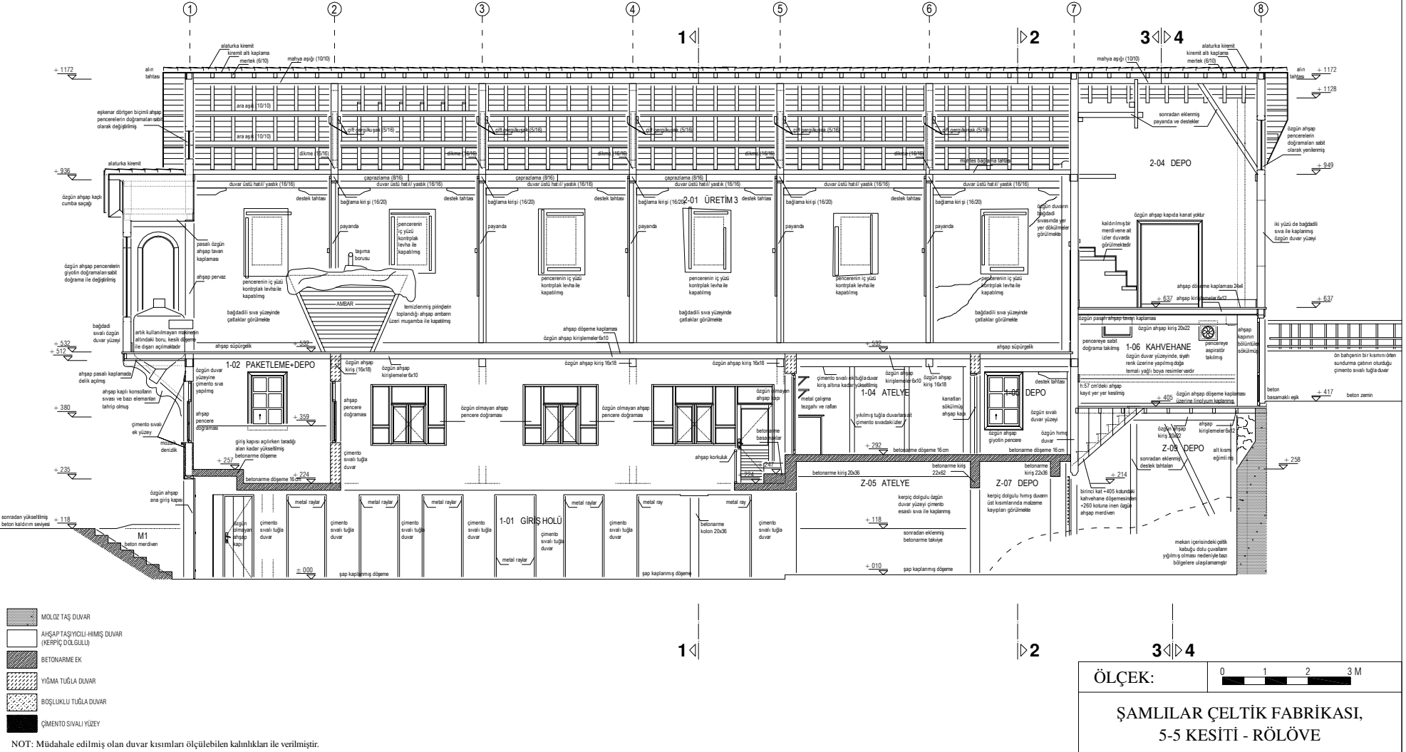
Şekil Ek 6.8 Şamlılar Çeltik Fabrikası, 5-5 Kesiti - Rölöve
