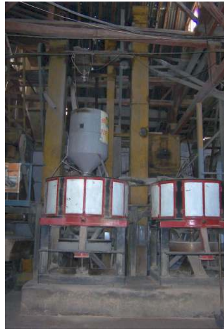
Foto Ek 1.148 Tosya, Bektaş Çeltik Fabrikası, parlatma taşı ve havalı parlatma taşı, Kasım 2005
