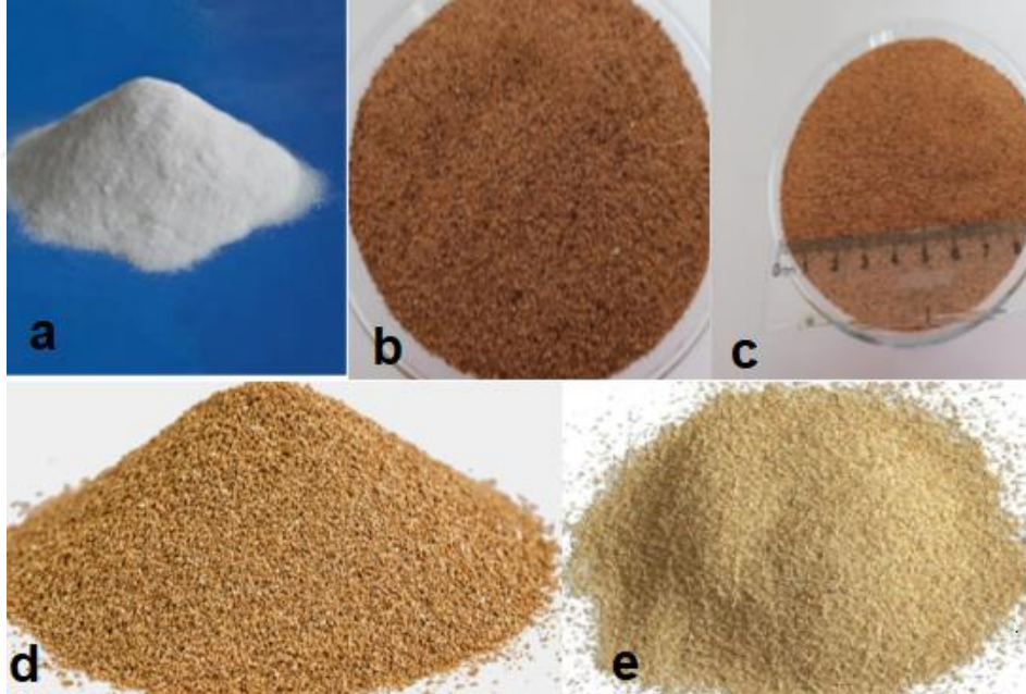
Şekil 4.20. Çalışmada kullanılan medyalara ait görseller (a. Sodyum bikarbonat, b. Fındık kabuğu granülü, c. Ceviz kabuğu granülü, d. Kayısı çekirdeği granülü, e. Mısır koçanı granülü).
