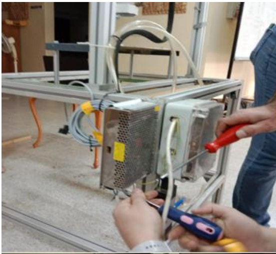
Şekil 4.18. Kontrol Ünitesi ve Arduino CNC Shield Kurulumu
