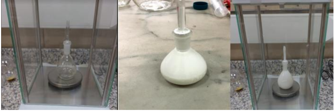
Şekil 4.4. Çalışmada kullanılan boyaların yoğunluk ölçümleri
