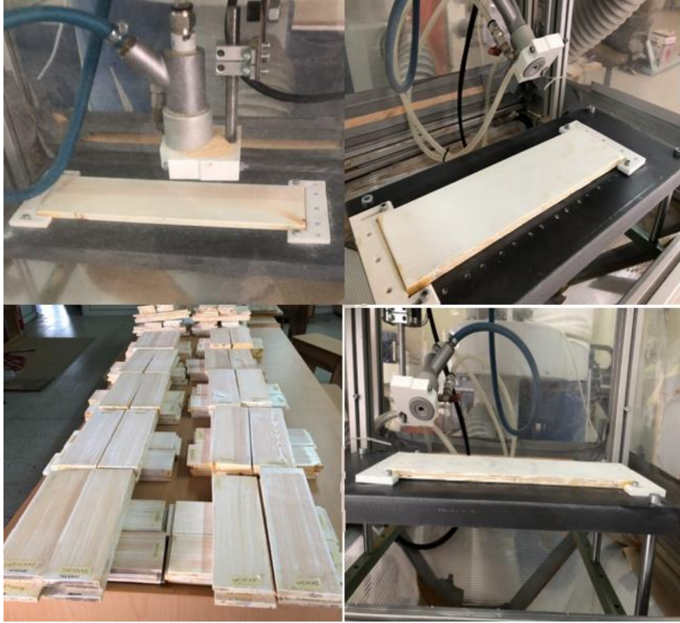
Şekil 4.22. KATTABOT ile yapılan boya temizleme işlemi
