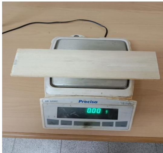
Şekil 4.26. Örneklerin aşınma miktarı ölçümü
