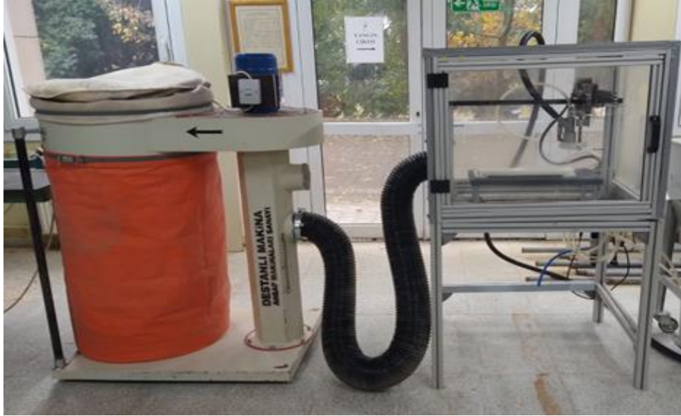
Şekil 4.14. KATTABOT Kabin ve Toz Emme Ünitesi
