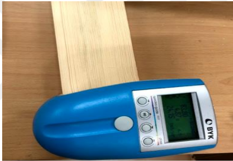
Şekil 4.23. Örneklerin Renk ve Parlaklık Ölçümü
