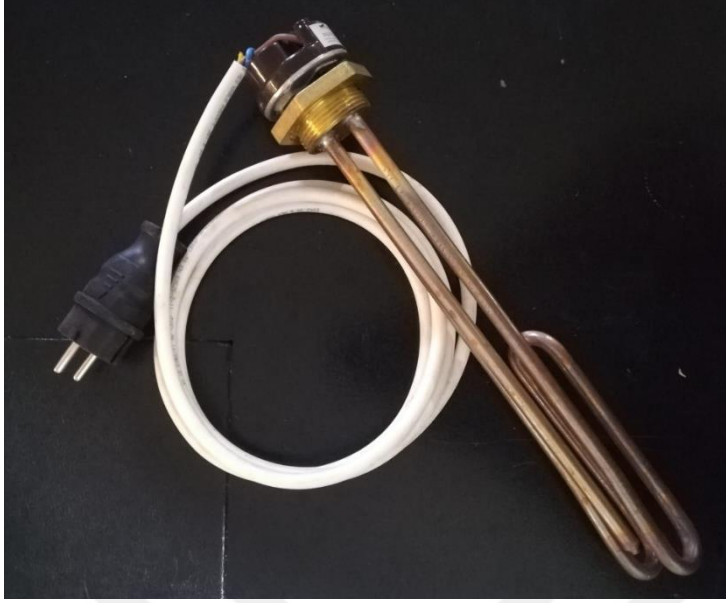
Şekil 5.11. 3kW ısıtıcı rezistans
