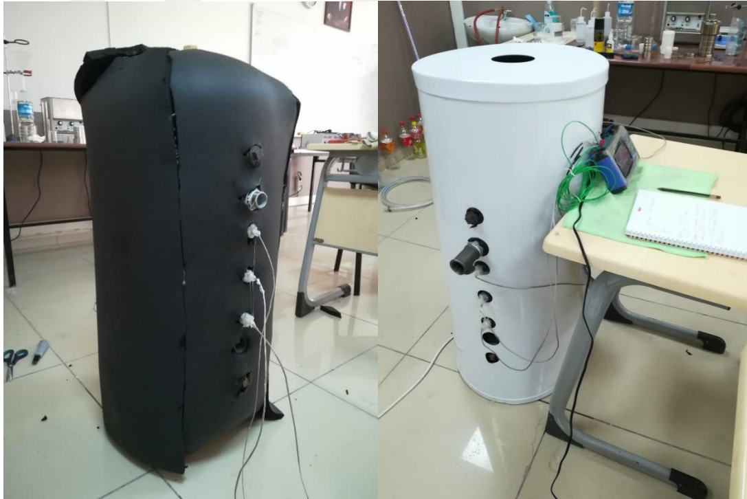
Şekil 5.19. Elastomerik kauçuk köpüğü yalıtımlı performans deneyler
