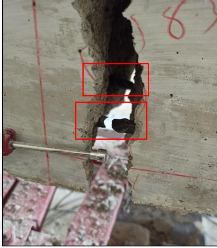
Şekil 4.33. K1-1 numunesinde kopan çekme donatısına ait görüntü
