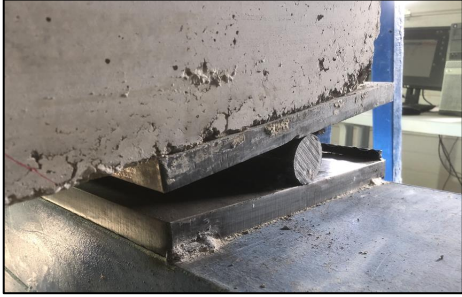
Şekil 4.120. K3-3 numunesine ait mesnetin deney sonunda ortaya çıkan durumu
