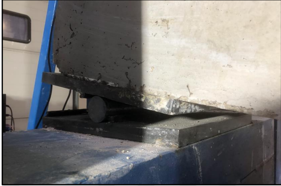
Şekil 4.106. K3-2 numunesi deney sonunda ortaya çıkan mesnet görüntüsü
