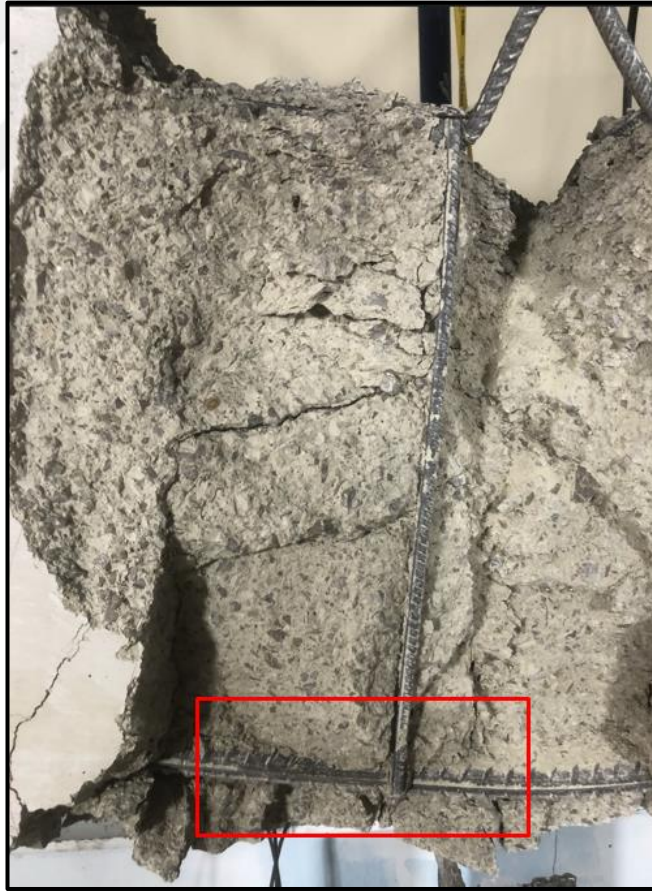
Şekil 4.82. K2-3 numunesi, çekme donatısının akma bölgesi
