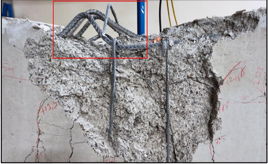
Şekil 4.94. K3-2 burkulma gerçekleşen basınç donatısı
