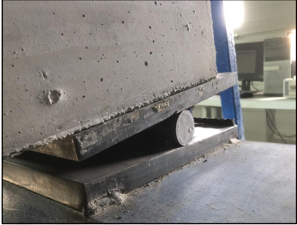
Şekil 4.68. K2-2 numunesinin mesnetlerinde deney sonunda ortaya çıkan görüntü
