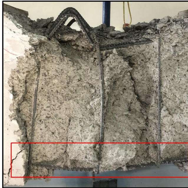
Şekil 4.123. K3-3 numunesi akma meydana gelen çekme donatısı
