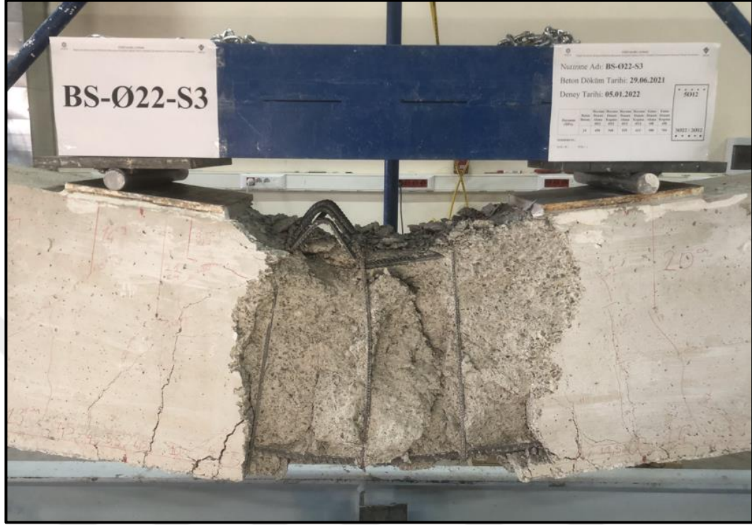
Şekil 4.118. K3-3 numunesi maksimum moment bölgesine ait çatlak görüntüsü
