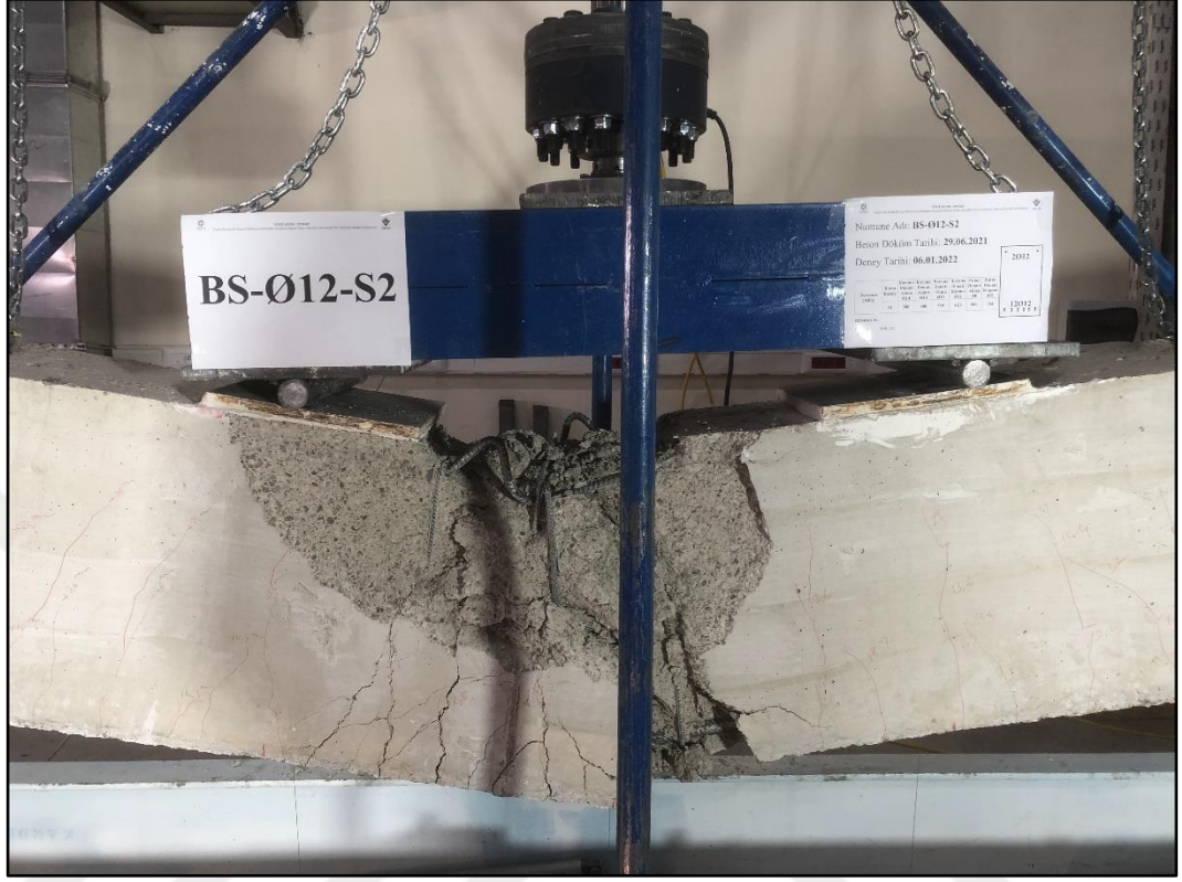
Şekil 4.66. K2-2 numunesi maksimum moment bölgesine ait çatlak görüntüsü
