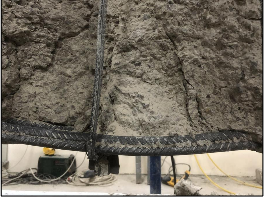
Şekil 4.108. K3-2 eğilme donatısında meydana gelen akma ve incelme
