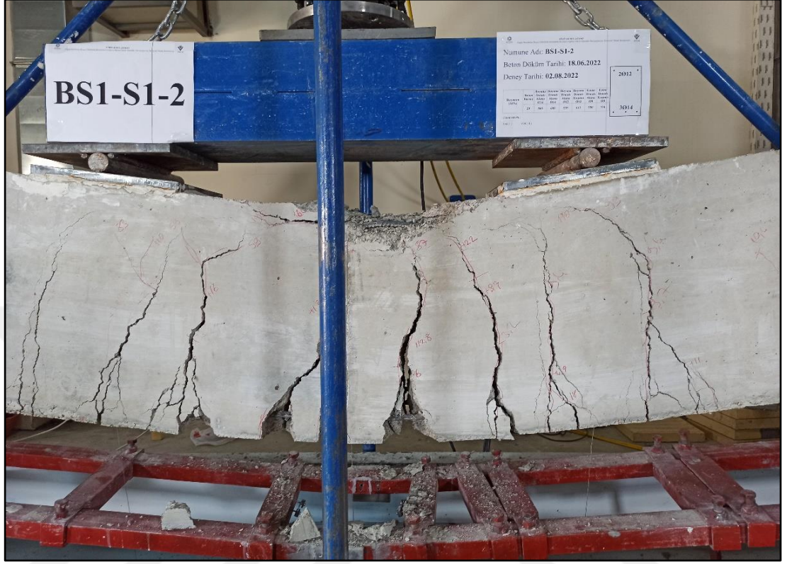
Şekil 4.31. K1-1 numunesi maksimum moment bölgesine ait çatlak görüntüsü
