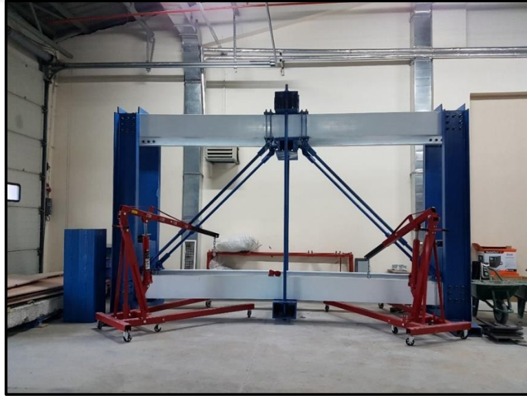
Şekil 3.12. Portatif vinçler ve yükleme çerçevesine ait görüntü (Şahin 2023)
