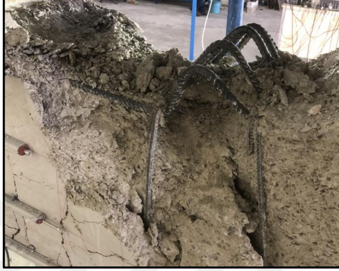
Şekil 4.122. K3-3 numunesi burkulma gerçekleşen basınç donatısı
