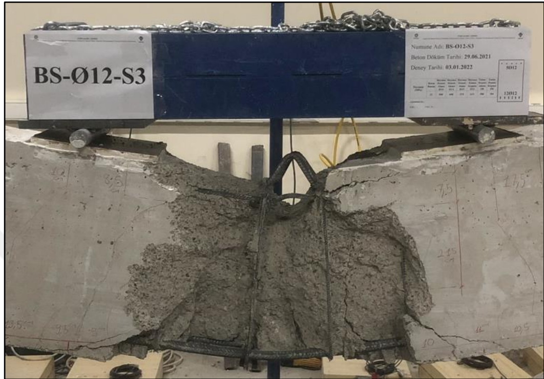
Şekil 4.104. K3-2 numunesi maksimum moment bölgesine ait çatlak görüntüsü
