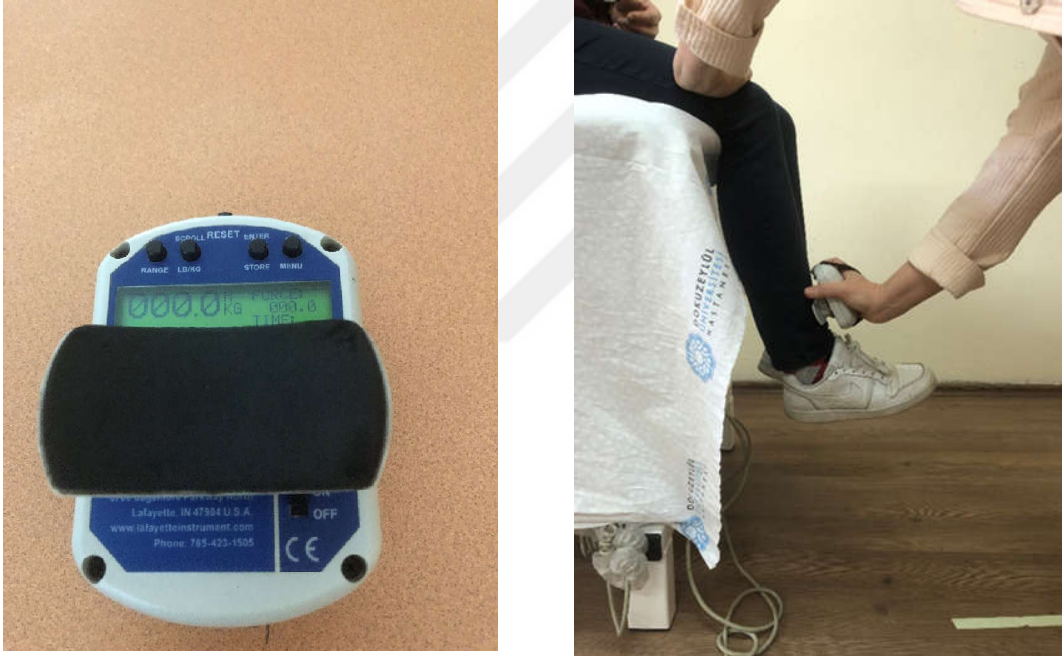
Şekil 6. Lafayette Hand-Held Dinamometre - Quadriceps Kas Kuvveti Ölçümü
