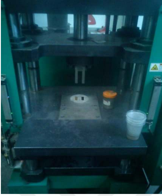
Şekil 6.3. Karıştırılan alaşımların soğuk preslenmesi
