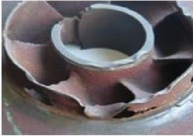
Şekil 5.9 Kavitasyon Aşınmasına Uğramış Pompa
