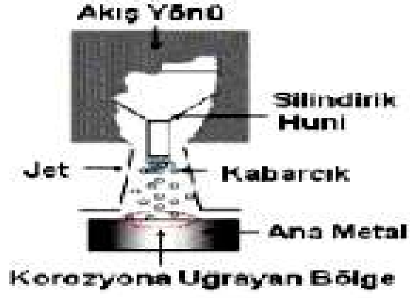
Şekil 5.8. Kavitasyon Aşınma Mekanizması
