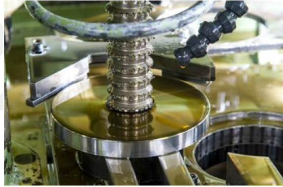
Şekil 2.40. Kesme sıvısının broşlama operasyonuna uygulanması
