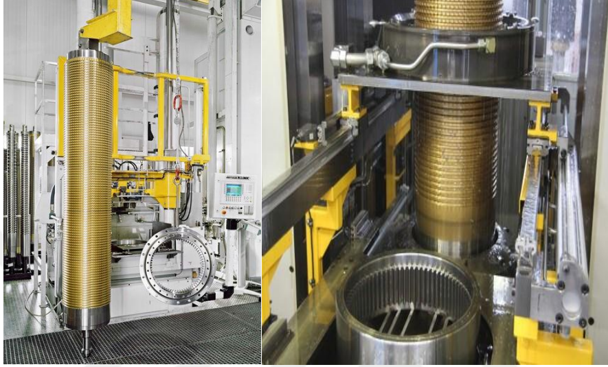
Şekil 2.39. Broş (tığ), broş tezgâhı ve broşlama
