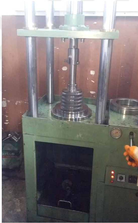
Şekil 2.25. Dikey broş tezgâhlarında dişli açma operasyonu [11]
