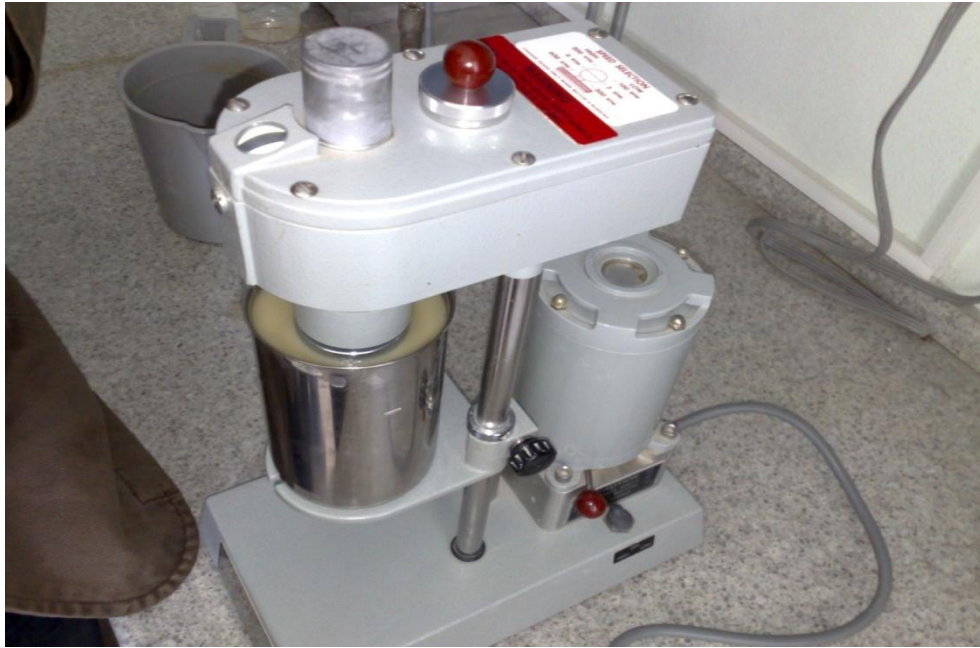
Şekil 4.2 Reoloji ölçümleri için kullanılan Fann Viskozimetre cihazı
