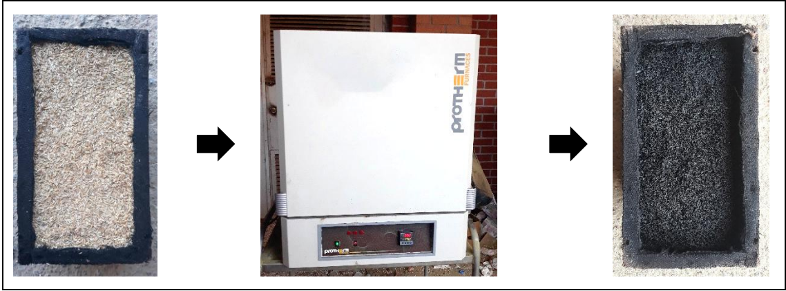
Şekil 3.3. Biyokütlenin biyokömüre dönüşüm süreçleri
