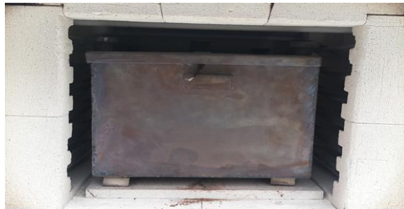
Şekil 3.2. Piroliz için hazırlanmış kabın kül fırını içerisine yerleştirilmesi
