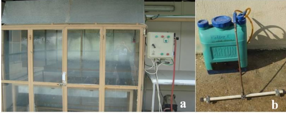
Şekil 3.4. Saksı denemelerinde kullanılan ilaçlama kabini (a), Tarla denemelerinde kullanılan sırt püverizatörü (b)
