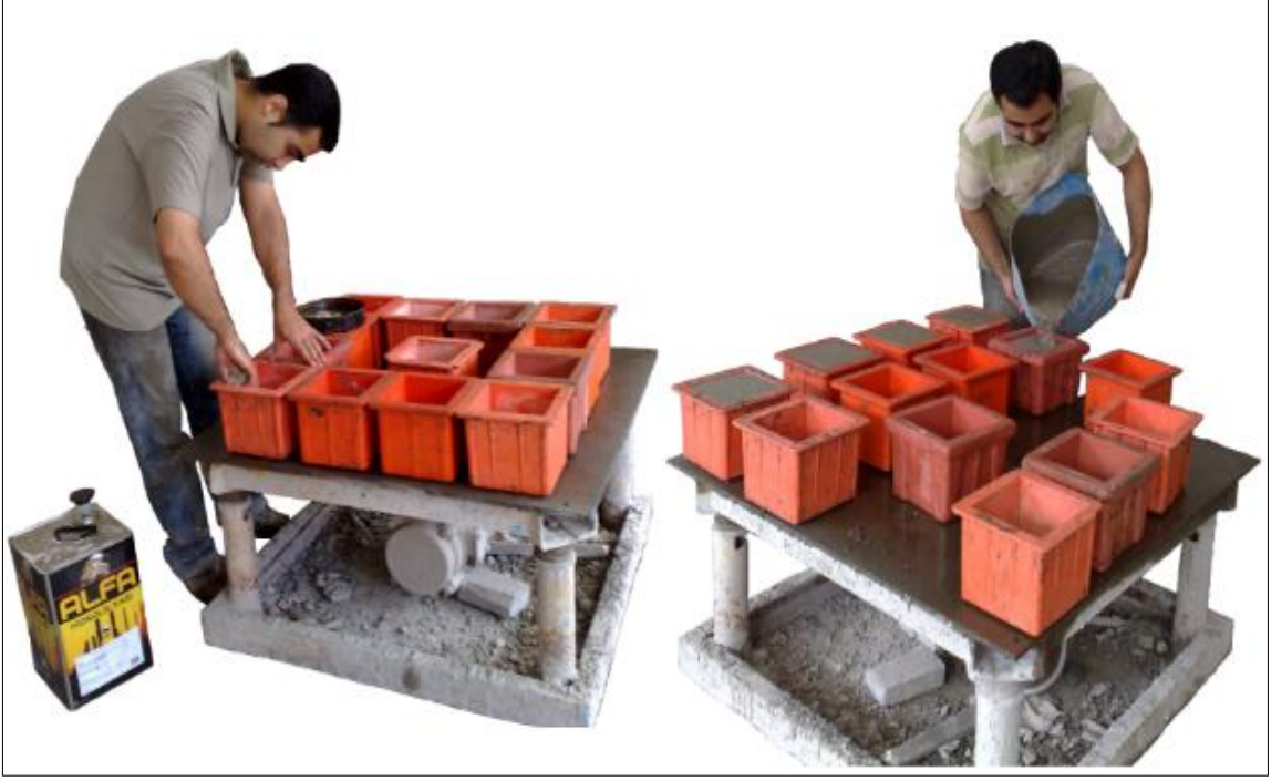
Şekil 8.12. Hazırlanan KYB lerin kalıplara yerleştirilmesi
