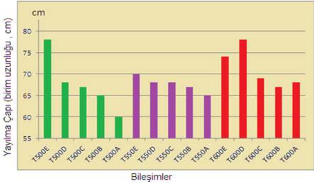
Şekil 9.2. Üretilen betonların çökme yayılma değerlerinin değişimi
