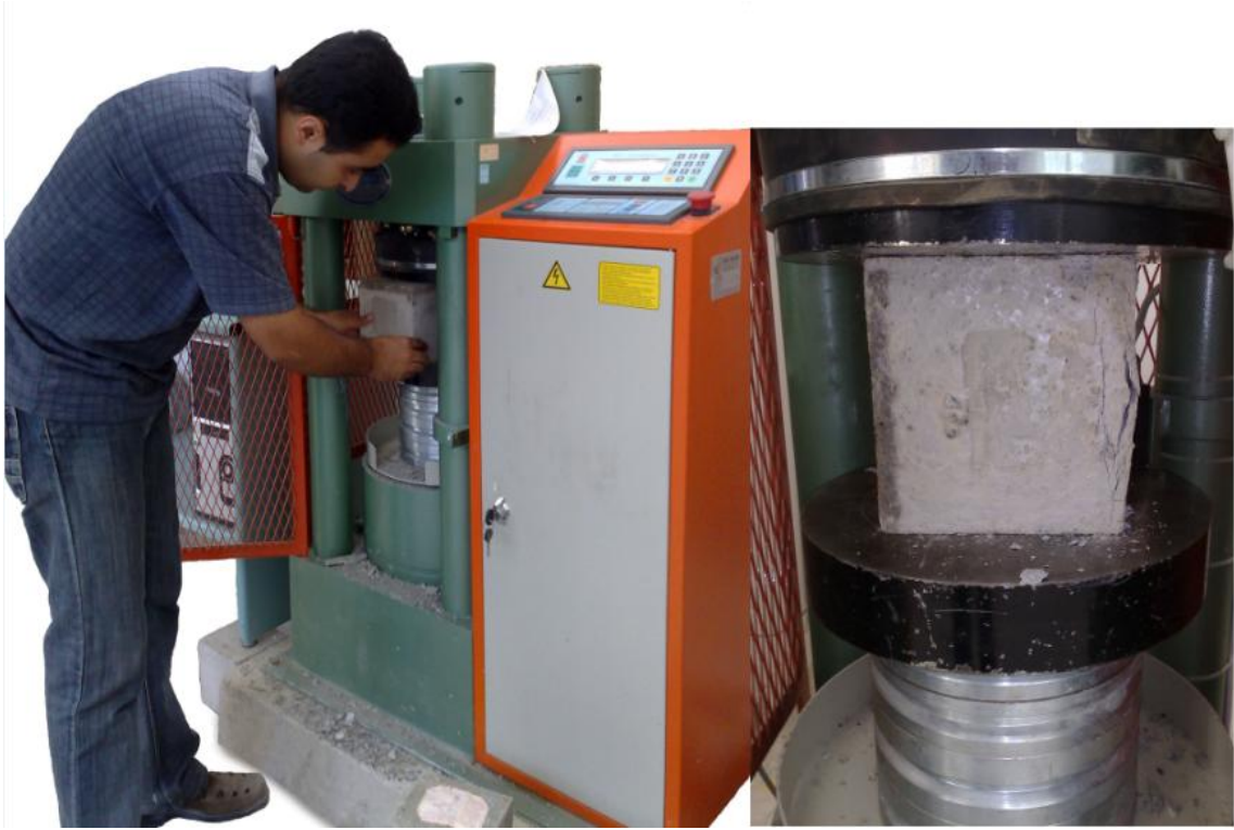
Şekil 8.17. Basınç dayanımının uygulamasının belirlenmesi
