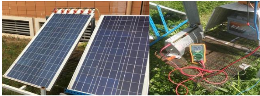
Şekil 3.4. Panel soğutma çalışması (Kerem, 2020)
