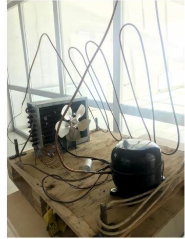
Şekil 4.22. Temel soğutma çevrimi ve deney sisteminde kullanımı
