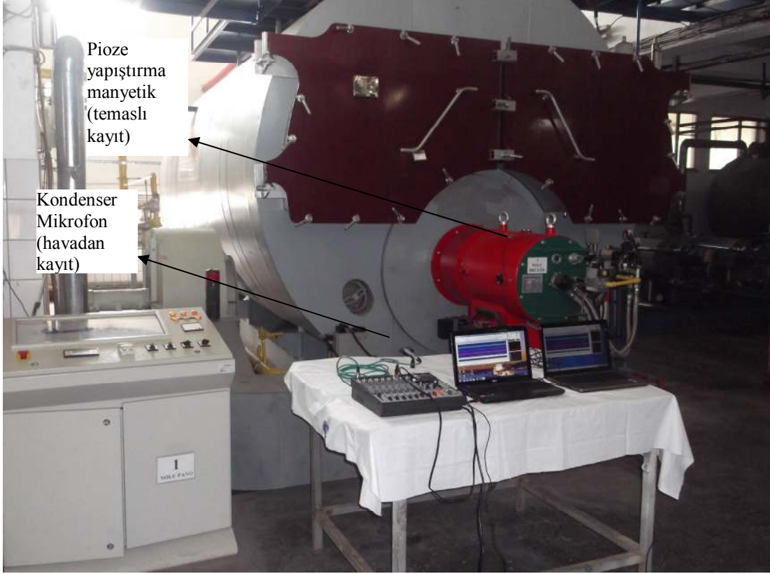
Şekil 3.1. Skoç tipi buhar kazanı ve brülör akustik bilgi kayıt deney düzeneği
