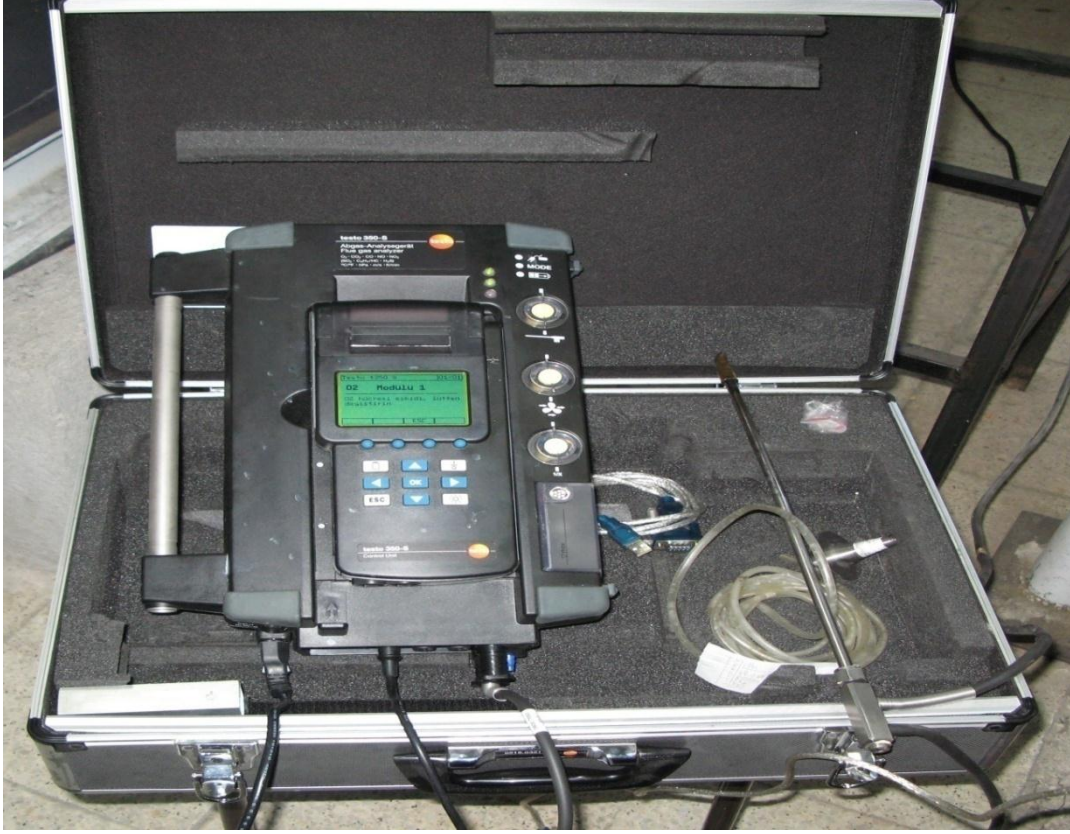
Resim 3.4 TESTO 350-S marka egzoz emisyon cihazı
