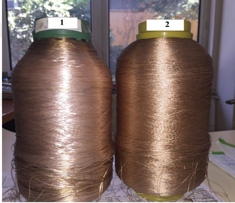
Şekil 29: 1- Fikse + %1 Enzim ile yapılan ön işlem sonrası boyama, 2-Fikse + Referans boyama (160 t/m bükümlü).
