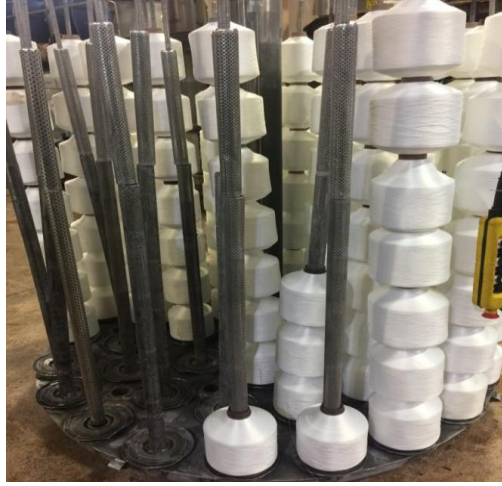
Şekil 2: Boya kazanının içine yerleştirilecek iğ düzeneği.
