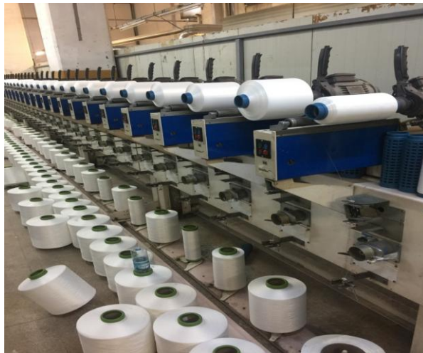
Şekil 23: SSM bobin aktarma makinesi.
