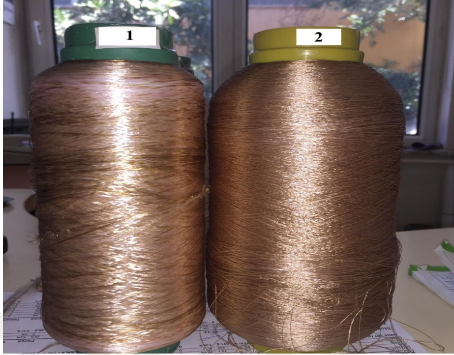
Şekil 30: 1-Fikse + % 2 Enzim ile yapılan ön işlem sonrası boyama, 2-Fikse + Referans boyama.
