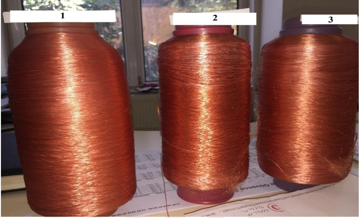
Şekil 31: 1- Fikse + Plazma işlemi + Boyama, 2 - Plazma işlemi + Boyama, 3- Fikse + Boyama (Bellini Makinesinde Boyama).
