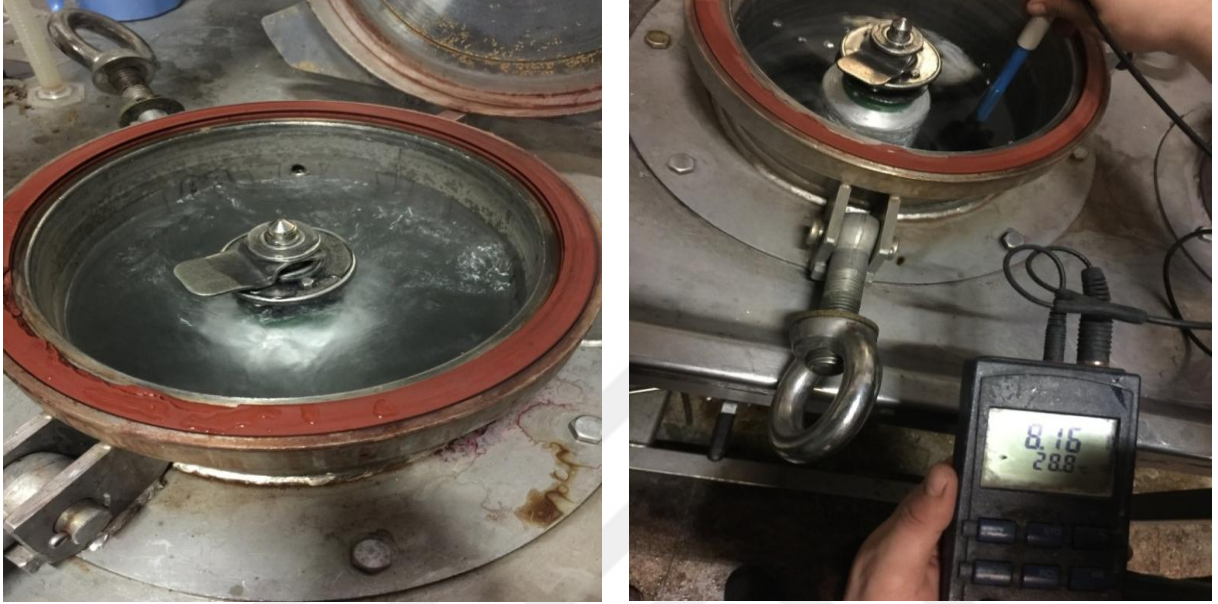
Şekil 24: Lipaz enzimi ile yapılan ön İşlem ve pH kontrolü.
