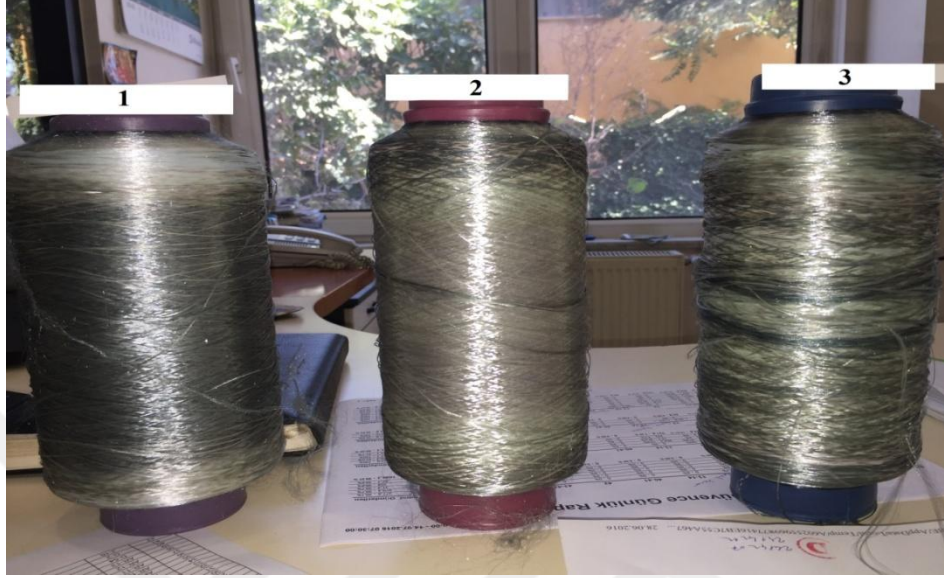
Şekil 32: 1- Fikse + Plazma işlemi + Boyama, 2-Plazma işlemi + Boyama, 3- Fikse + Boyama (Laip Makinesinde Boyama).
