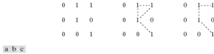
Şekil 2.8 (a) Piksellerin düzenlenmesi; (b) merkez piksele 8-bitişik olan pikseller (çizgili olarak gösterilmiştir); (c) m-bitişikliği.
