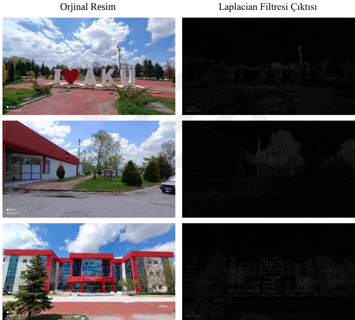
Şekil 3.6 Laplacian filtresinin Matlab programındaki sonuçları.
