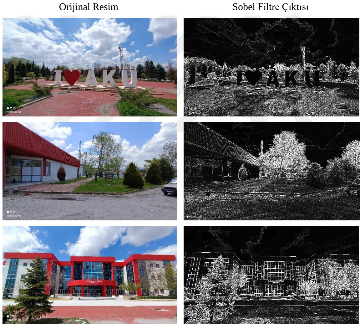
Şekil 3.2 Sobel filtresinin Matlab programındaki sonuçları.
