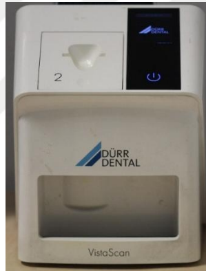
Şekil 3.9. Fosfor Plak Tarayıcısı
