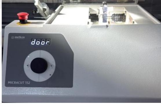
Şekil 3.2. Hassas Kesim Cihazı
