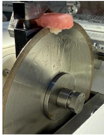
Şekil 3.3. Hassas Kesim Cihazı ile Örneklerin Elde Edilmesi
