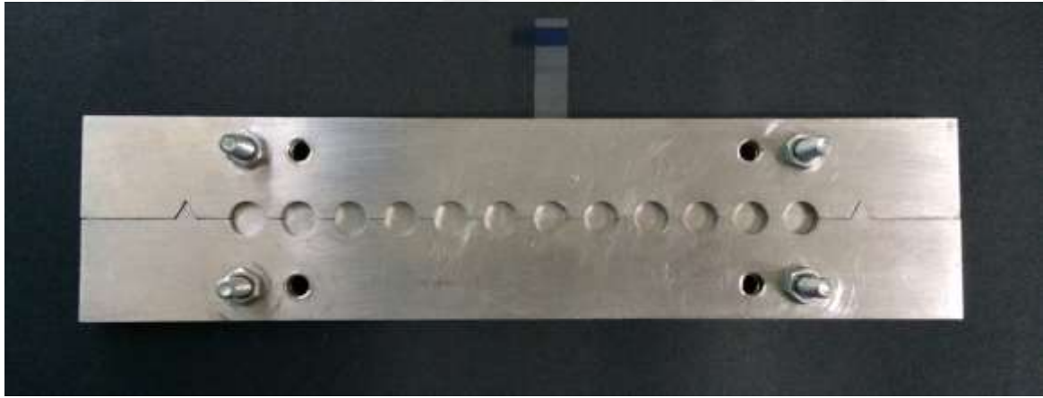
Şekil 3-10: Kompozit numunelerin metal kalıptaki silindirik yuvaya yerleştirilmesinden önce metal tabla üzerine şeffaf bant yerleştirilmesi
