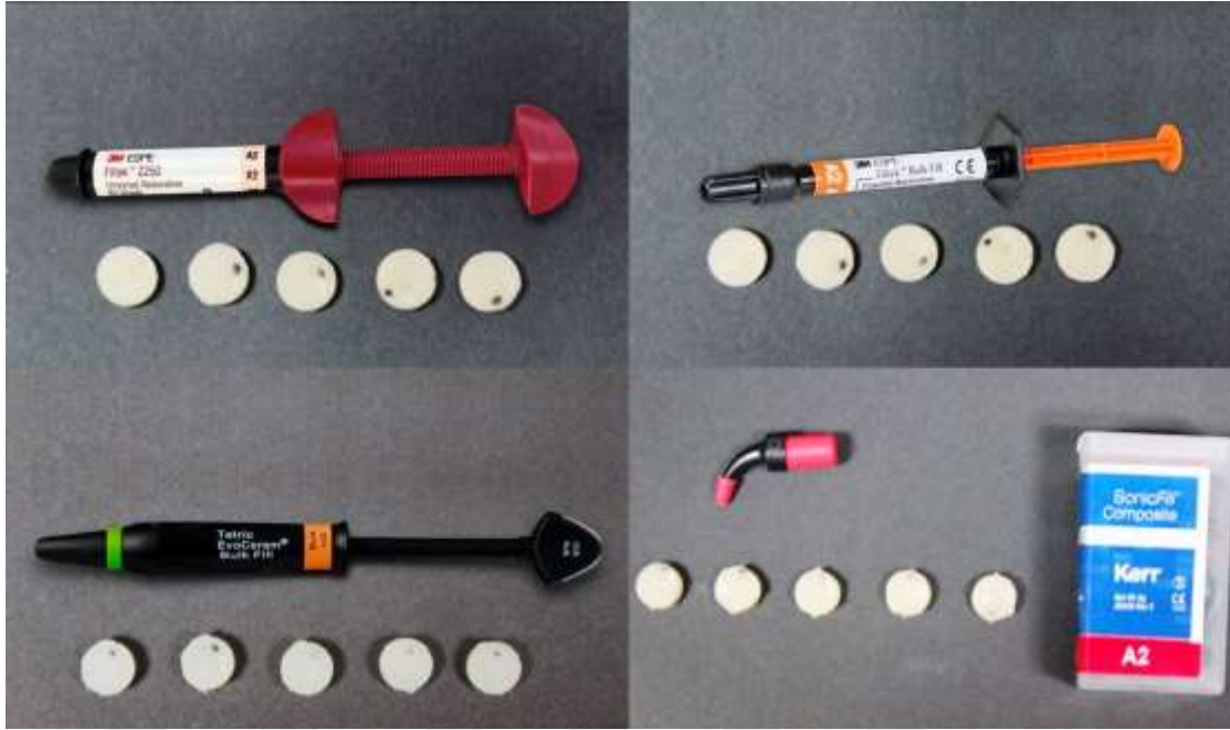
Şekil 3-14: Bitirme ve cila işlemleri tamamlanan numunelerin alt yüzeylerinin aeratör ve elmas rond frez kullanılarak numaralandırılması
