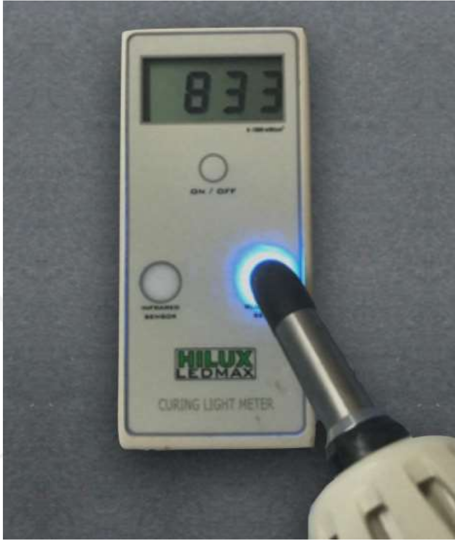
Şekil 3-6: Halojen ışık cihazının (Optilux 501) ışık gücünün dijital bir radyometre (Hilux Curing Light Meter) yardımıyla ölçülmesi
