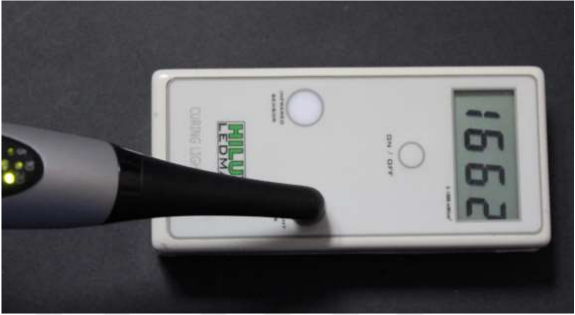
Şekil 3-8: LED ışık cihazının (Demi Ultra) ışık gücünün dijital bir radyometre (Hilux Curing Light Meter) yardımıyla ölçülmesi
